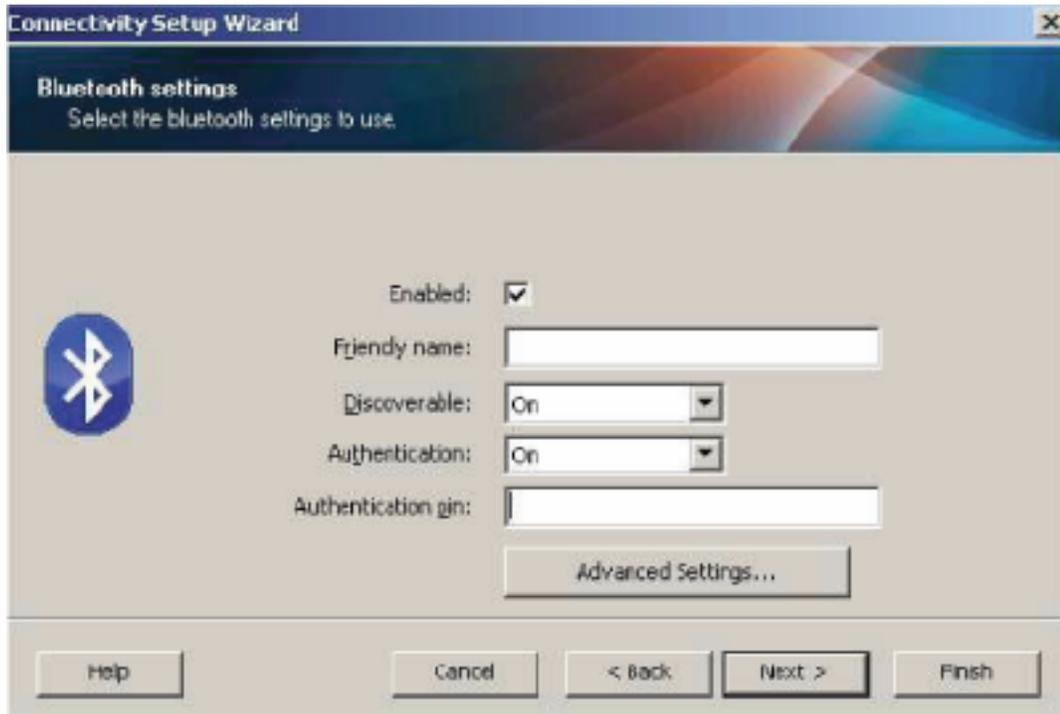
Si el dispositivo central utiliza BT v2.1 o versiones más recientes, esta configuración no tiene efecto. BT v2.1 y versiones más recientes utilizan Secure Simple Pairing (SSP), que no requiere el uso de un PIN.
