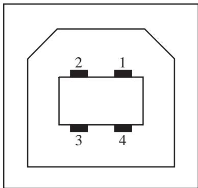
**Ožičenje – USB priključnica stila B za priključivanje na pisač ili uređaj**
