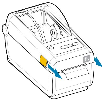
3. Uklonite sve nepričvršćene ispitne naljepnice iz odjeljka za naljepnice.
