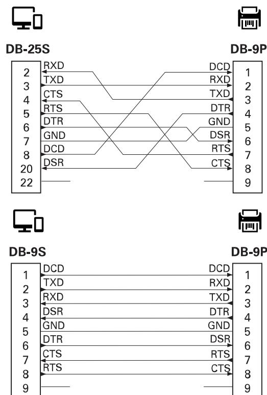
Povezivanje s uređajima DCE – kada se pisač s podatkovnom komunikacijskom opremom (DCE), kao što je modem, povezuje putem sučelja RS-232, treba upotrijebiti STANDARDNI (jednosmjerni) kabel za sučelje RS-232.
