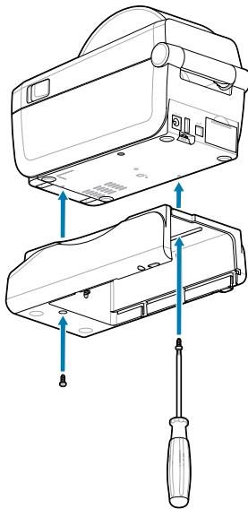
2. Baterijsku bazu za pisač pričvrstite s dva isporučena vijka. Zategnite vijke šesterokutnim ključem #10. Baterija je spremna za instalaciju u baterijsku bazu pisača.
