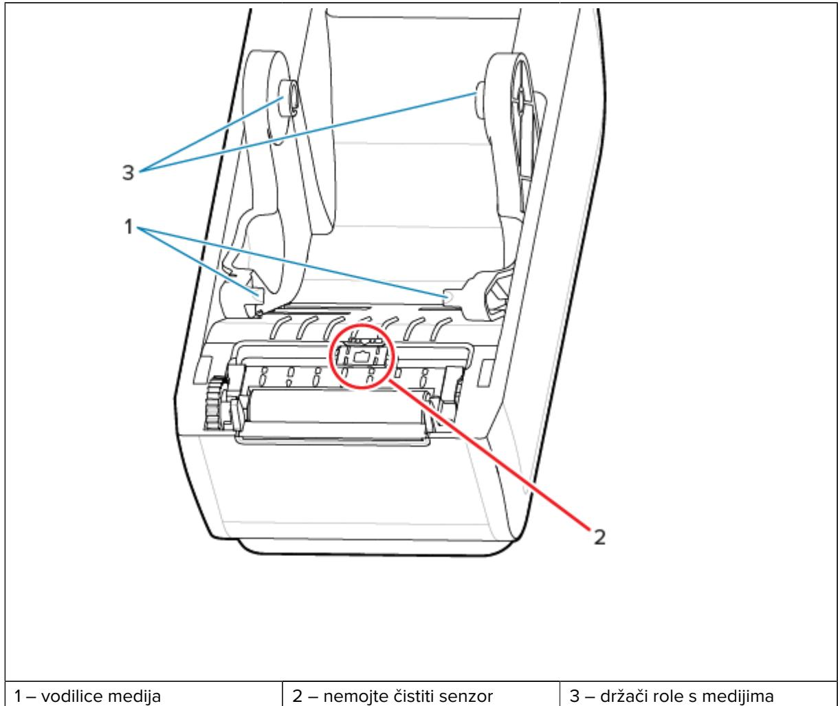
4. Obrišite površine (označene narančasto) kako biste uklonili ljepilo i ostale nečistoće. Nemojte čistiti sklop senzora (1).
