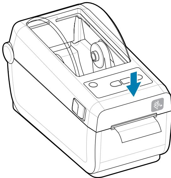
Kalibrirajte pisač za novi medij. Za pravilan rad treba podešiti senzore pisača tako da detektiraju naljepnicu, podlogu i udaljenost između naljepnica.
