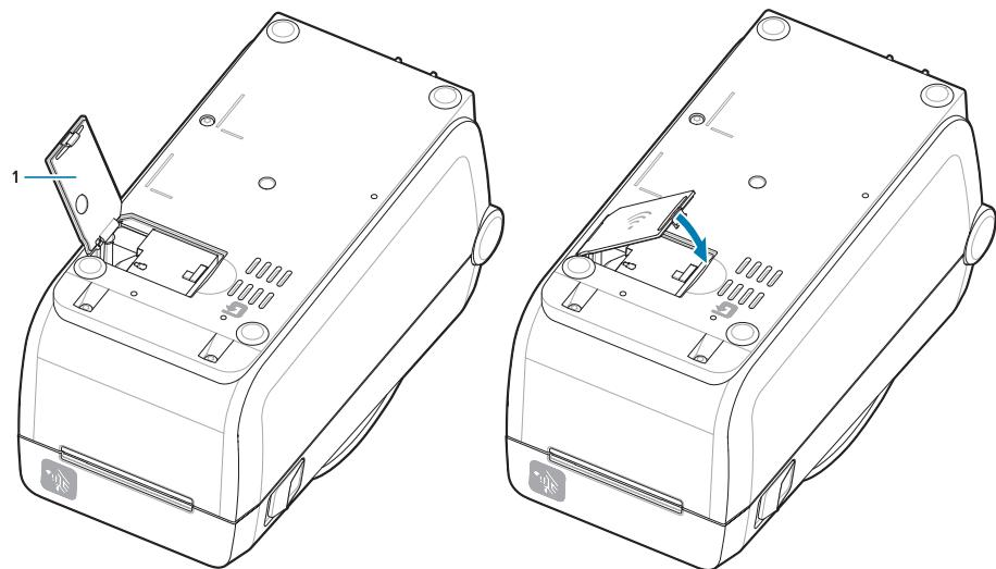
5. Zalijepite tri isporučene naljepnice za na donju stranu pisača (1). Te naljepnice (2 i 3) pomažu pri konfiguraciji (i kasnjim promjenama konfiguracije) pisača. Te naljepnice s konfiguracijom pisača služe za mobilne aplikacije, upotrebu skenera i podršku za pisač.
