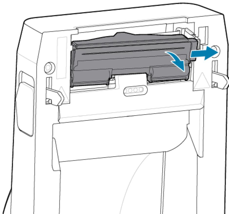
3. Pažljivo, ali čvrsto izvucite dva konektora kabelskih snopova ispisne glave (1) iz ispisne glave (2). Izvucite vodič uzemljenja (3) iz ispisne glave.
