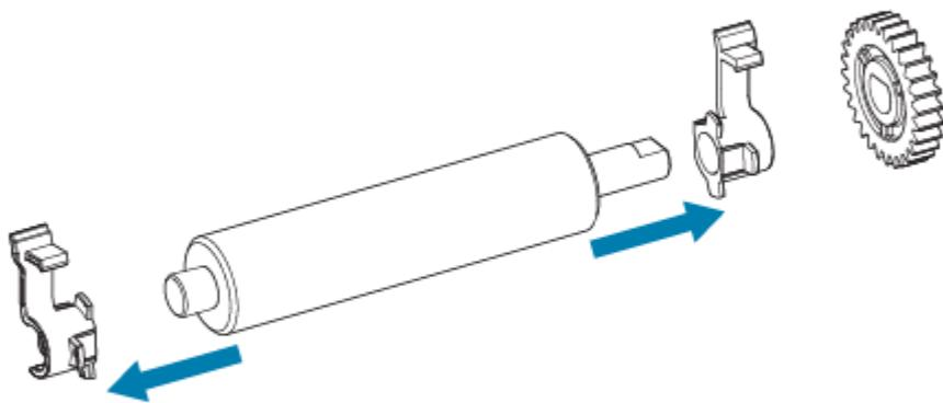
5. 청소만 수행 - 알코올을 적신 면봉으로 플래튼을 청소합니다. 중앙에서 바깥 방향으로 청소합니다. 모든 롤러 표면이 닦힐 때까지 이 과정을 반복합니다. 접착제가 많이 쌓이거나 라벨 걸림이 발생한 경우, 초기 청소로는 접착제와 오일이 얇아지기는 하지만 완전히 제거되지는 않을 수 있으므로 새 면봉으로 반복해서 잔류 오염물을 제거합니다.
