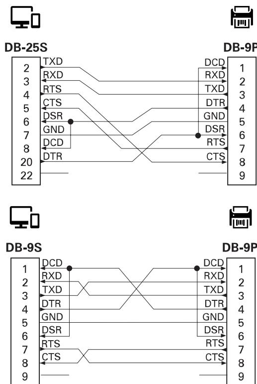
DTE 장치에 교차 연결 - 프린터는 DTE(데이터 터미널 장치)로 구성되어 있습니다. 프린터를 기타 DTE 장치(예: PC의 직렬 포트)에 연결하려면 RS-232 널 모뎀(크로스오버) 케이블을 사용합니다.
