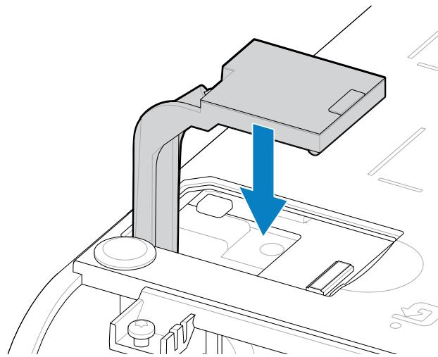
8. Выровняйте короткую сторону крышки отсека модуля беспроводного подключения с короткой стороной отверстия.
