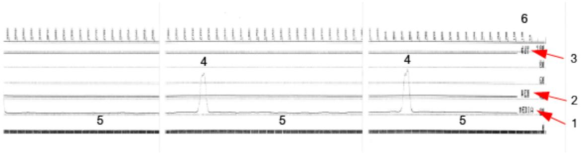
**Рисунок 11** Профиль датчика (носитель с черными метками)
