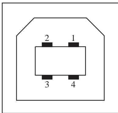
**Назначение контактов разъема USB типа В для подключения к принтеру или устройству**
