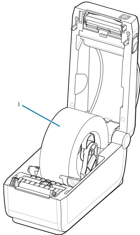
Пример рулона этикеток с катушкой с внутренним диаметром 38,1 мм (1,5 дюйма), установленного на адаптеры для катушек рулонов носителей.
