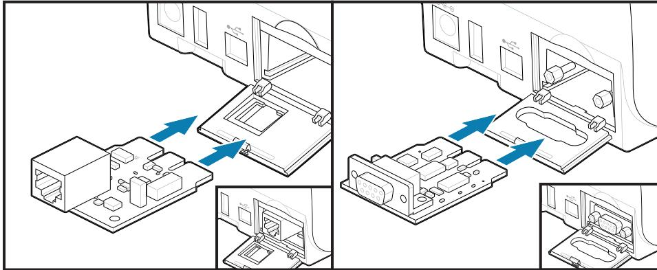
**Установка дверцы доступа к модулю подключения**
