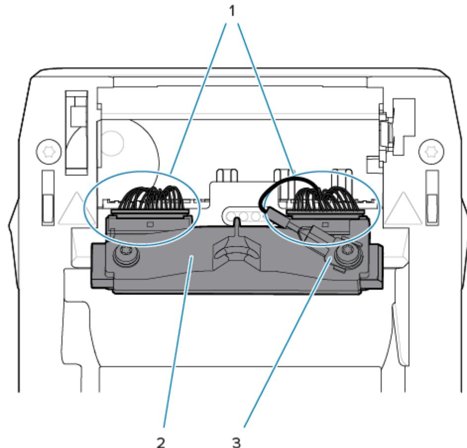
4. Совместите печатающую головку с принтером. Подсоедините разъем кабеля с правой стороны печатающей головки. Разъем закреплен для вставки только в одном положении.
