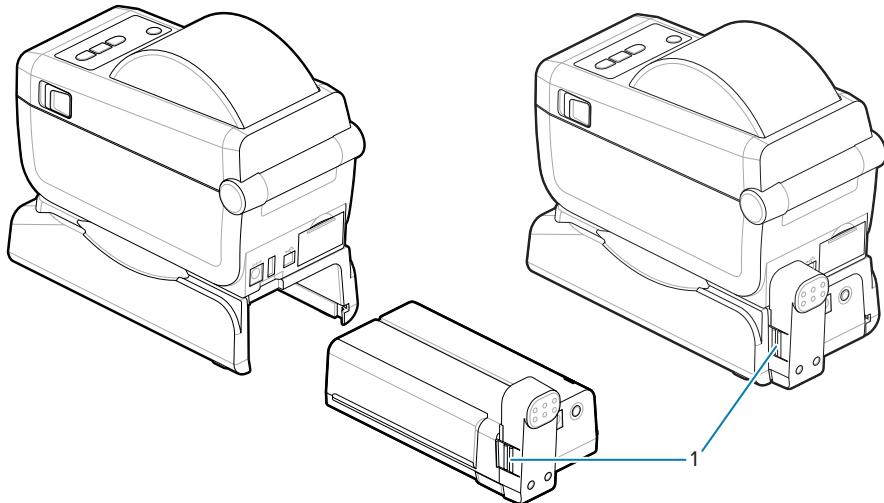
3. Присоедините блок питания принтера к аккумулятору, чтобы вывести аккумулятор из режима выключения и начать первую зарядку.
