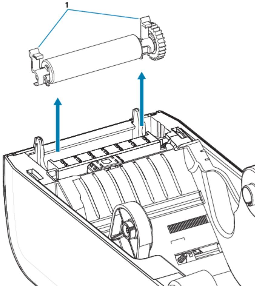
4. Снимите шестерню и два подшипника с оси опорного валика.
