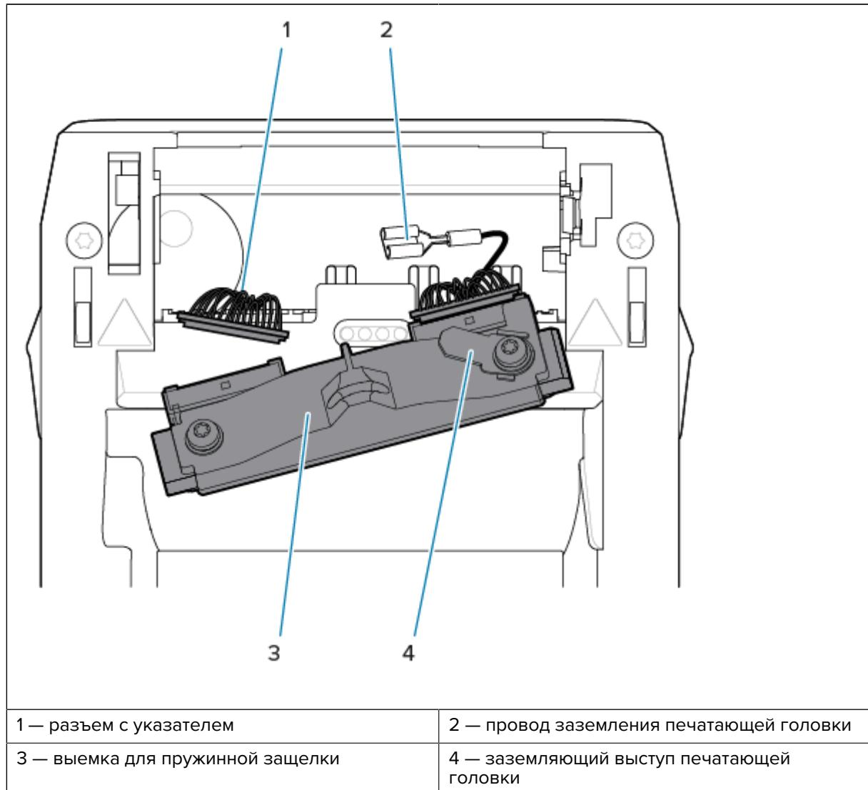
7. Вставьте левую сторону узла печатающей головки в утопленный паз (1) на левой стороне принтера (обведено красным цветом).
