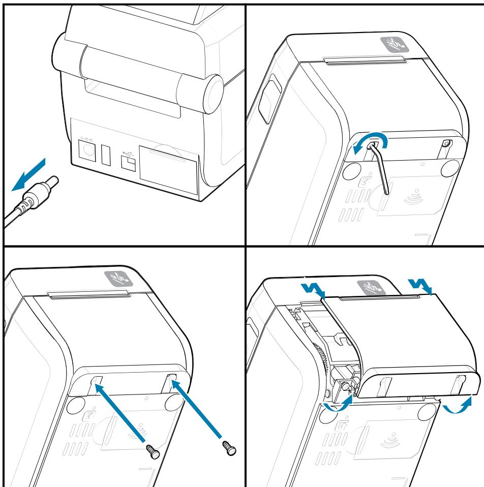
**Установка дополнительных модулей для работы с носителями**
