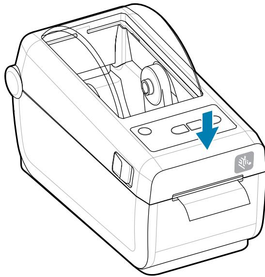
Выполните калибровку принтера для работы с новым носителем. Необходимо настроить датчики принтера, чтобы считывание этикеток, подложки и расстояния между этикетками работало правильно.
