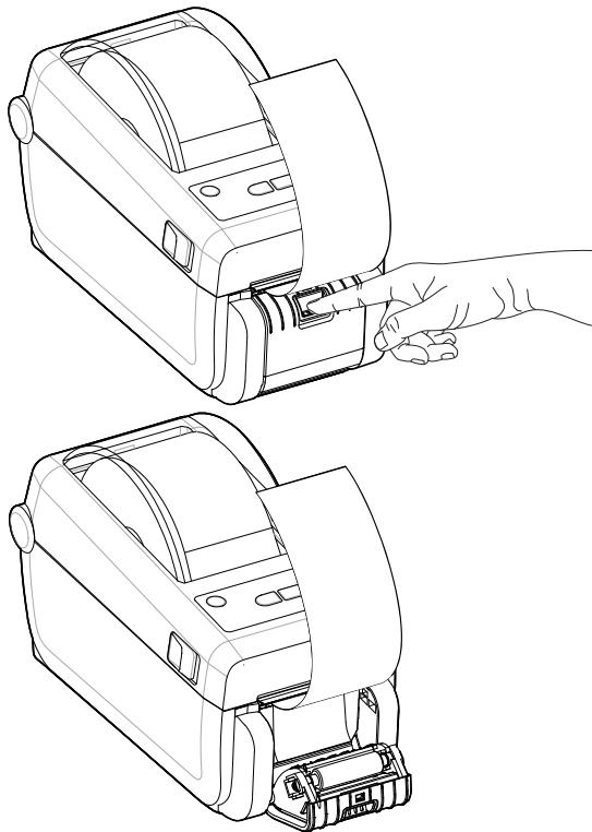
3. Вставьте подложку между дверцей отделителя и корпусом принтера.
