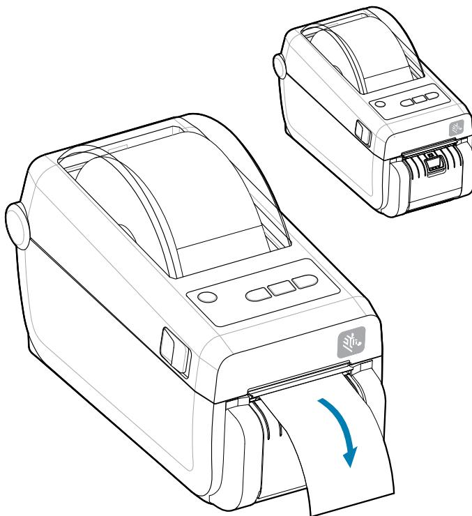
2. Поднимите подложку над верхней частью принтера. Потяните за фиксатор золотистого цвета в центре дверцы отделителя этикеток в сторону от принтера, и дверца откроется.
