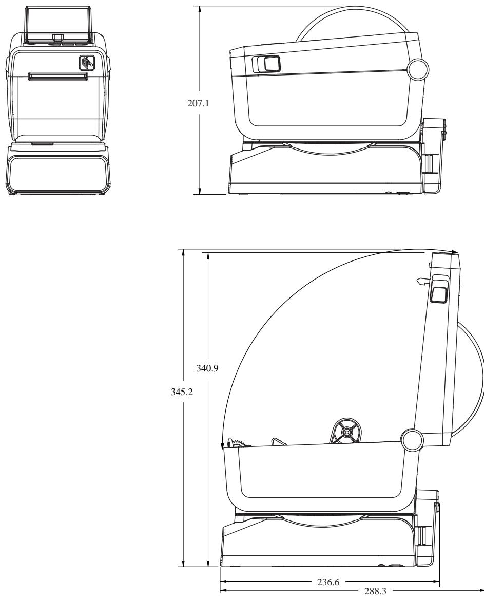
Рисунок 20 Стандартный монтаж ZD411D (размеры в миллиметрах)
