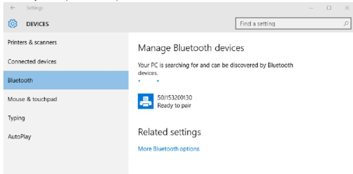
4. Нажмите значок **printer (принтера)**, а затем кнопку **Pair (Pair) (Связать)** для этого принтера..
