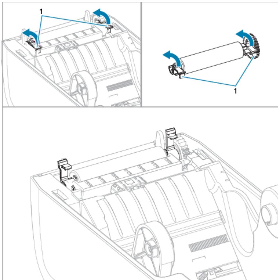
3. Поднимите опорный валик из нижней части корпуса принтера с помощью рычагов подшипников (1).
