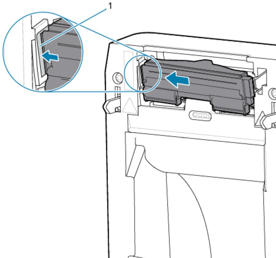
8. Совместите выемку для пружинной защелки (1) на задней стороне печатающей головки с самой защелкой. Вставьте правую сторону печатающей головки в принтер таким образом, чтобы она защелкнулась и зафиксировалась в принтере.
