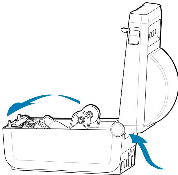
3. Отрегулируйте конечное положение направляющих носителя при помощи защелки серого цвета. Он расположен на внешней стороне левого держателя рулона носителя. Настройте ширину конечного положения с помощью листа сложенного веером носителя. Сдвиньте
