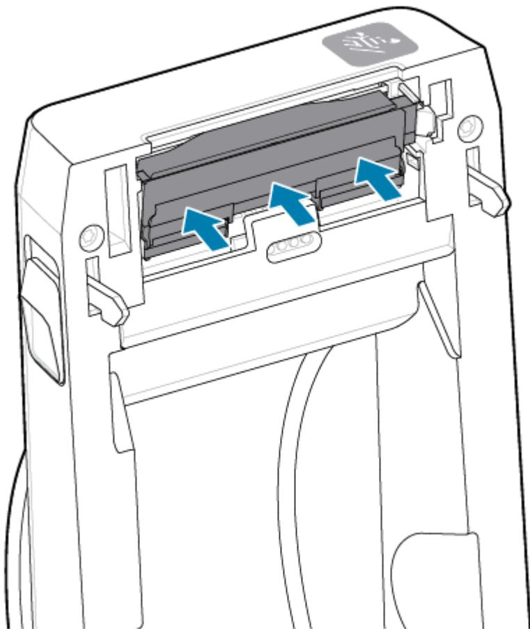
1. Выполните очистку печатающей головки. С помощью нового чистящего карандаша очистите с печатающей головки жирные пятна (отпечатки пальцев) и мусор. Выполняйте очистку печатающей головки от центра к краям. См. [Очистка печатающей головки в принтере ZD411D](#) на странице 126.
