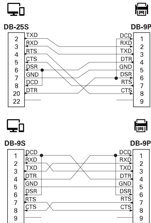
Межсоединение с устройствами DTE: принтер настроен как оконечное оборудование данных (DTE). Для подключения принтера к другим устройствам DTE (таким как последовательный порт персонального компьютера) используйте нуль-модемный (перекрестный) кабель RS-232.
