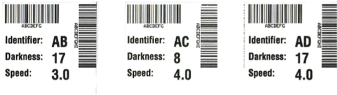
Slika 6 Probni otisak testa kvaliteta štampe
