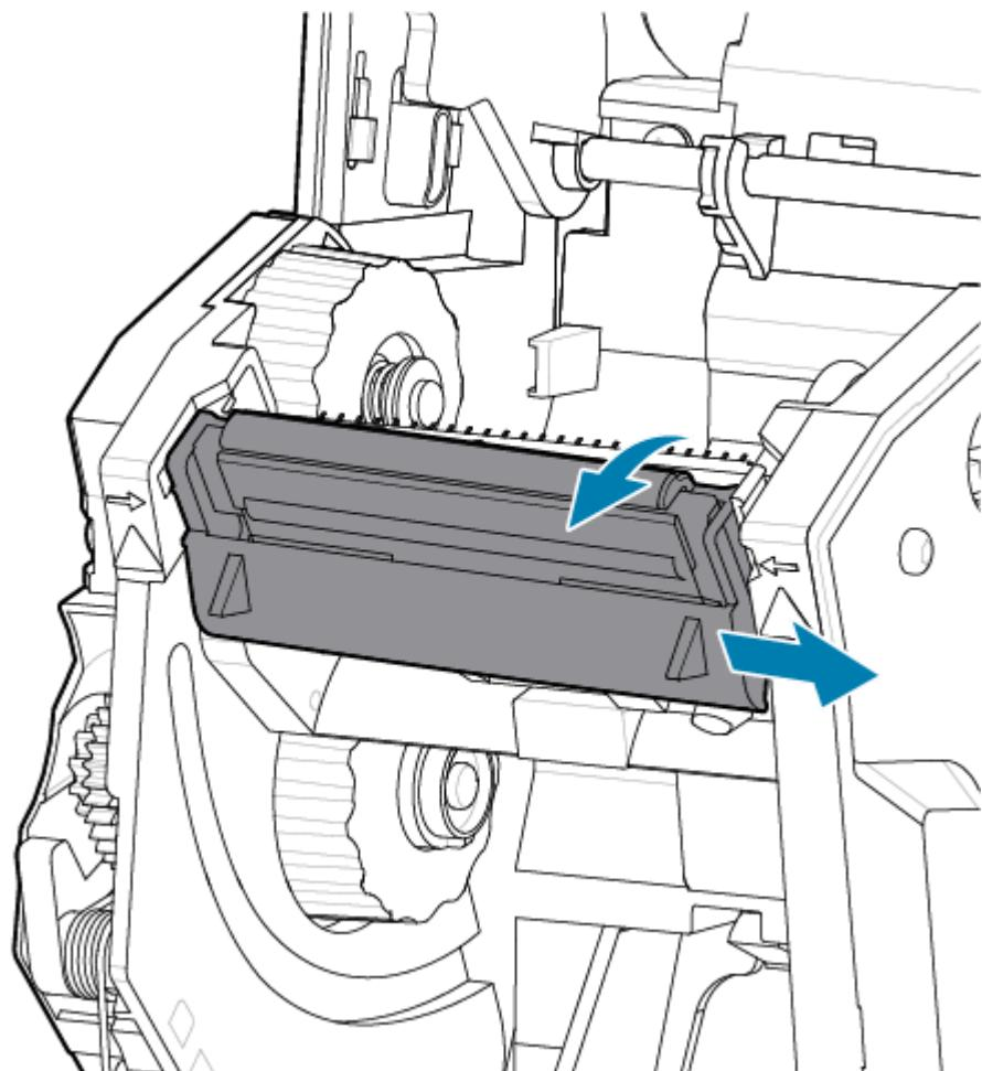
3. Осторожно, но с необходимым усилием отсоедините от печатающей головки две подключенные к ней колодки разъемов с пучками кабелей.
