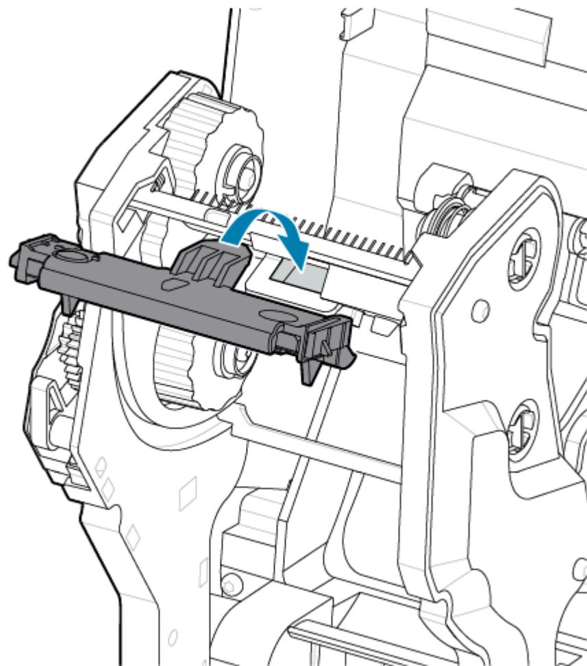
7. Вставьте выступ на левой стороне узла печатающей головки в утопленный паз на левой стороне каретки для ленты.
