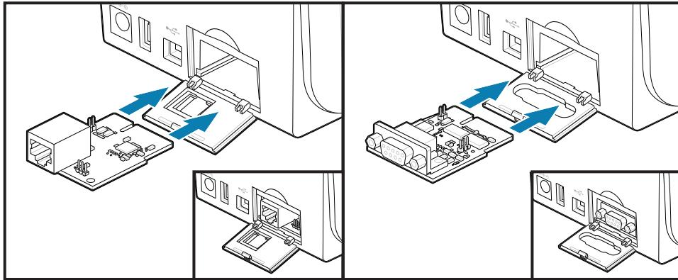
**Установка дверцы доступа к модулю подключения**
