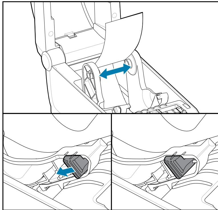
4. Вставьте носитель через отверстие в задней части принтера и поместите его между направляющими носителя и держателями рулона.
