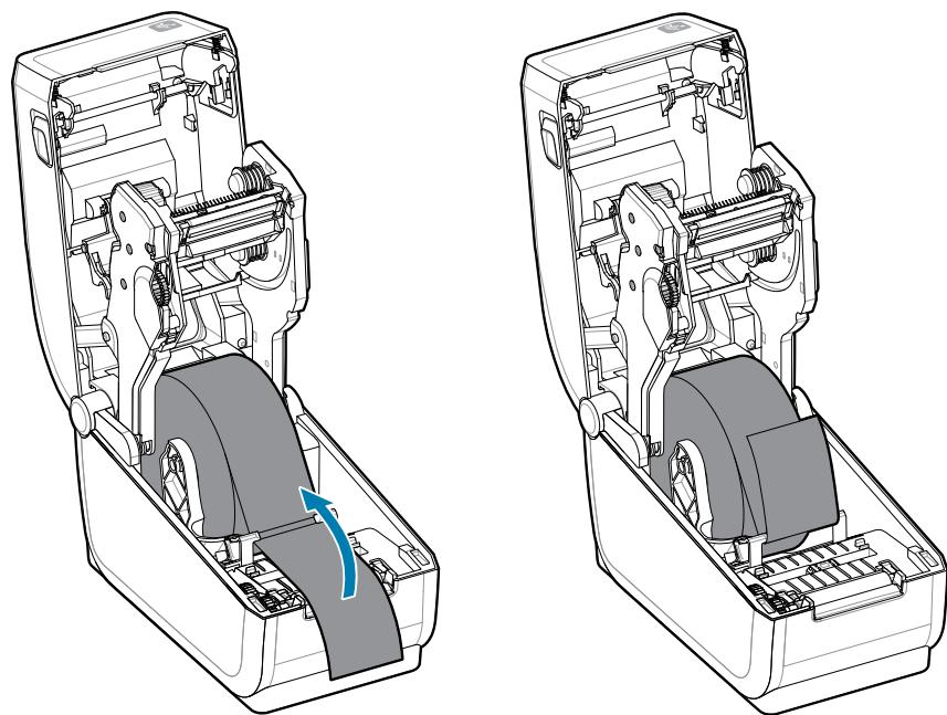
7. Выровняйте передвижной датчик носителя в соответствии с используемым типом носителя.
