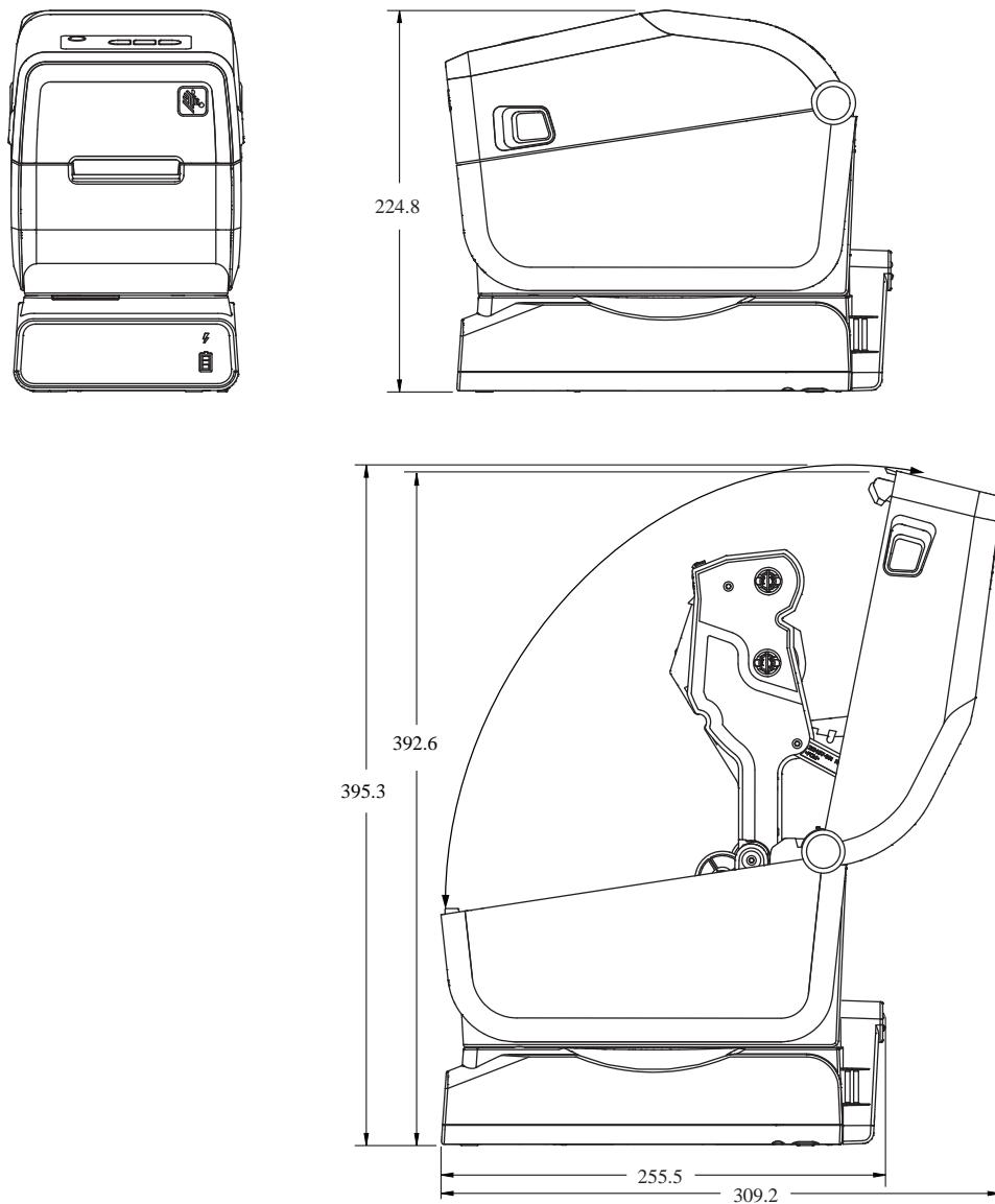
**Рисунок 17** Стандартный монтаж принтера ZD411T
