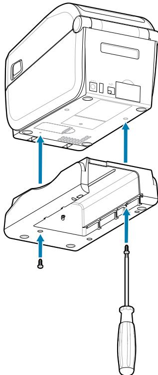
2. С помощью двух винтов из комплекта поставки закрепите аккумуляторную базовую станцию на принтере. Затяните винты с помощью звездообразного гаечного ключа №10.
