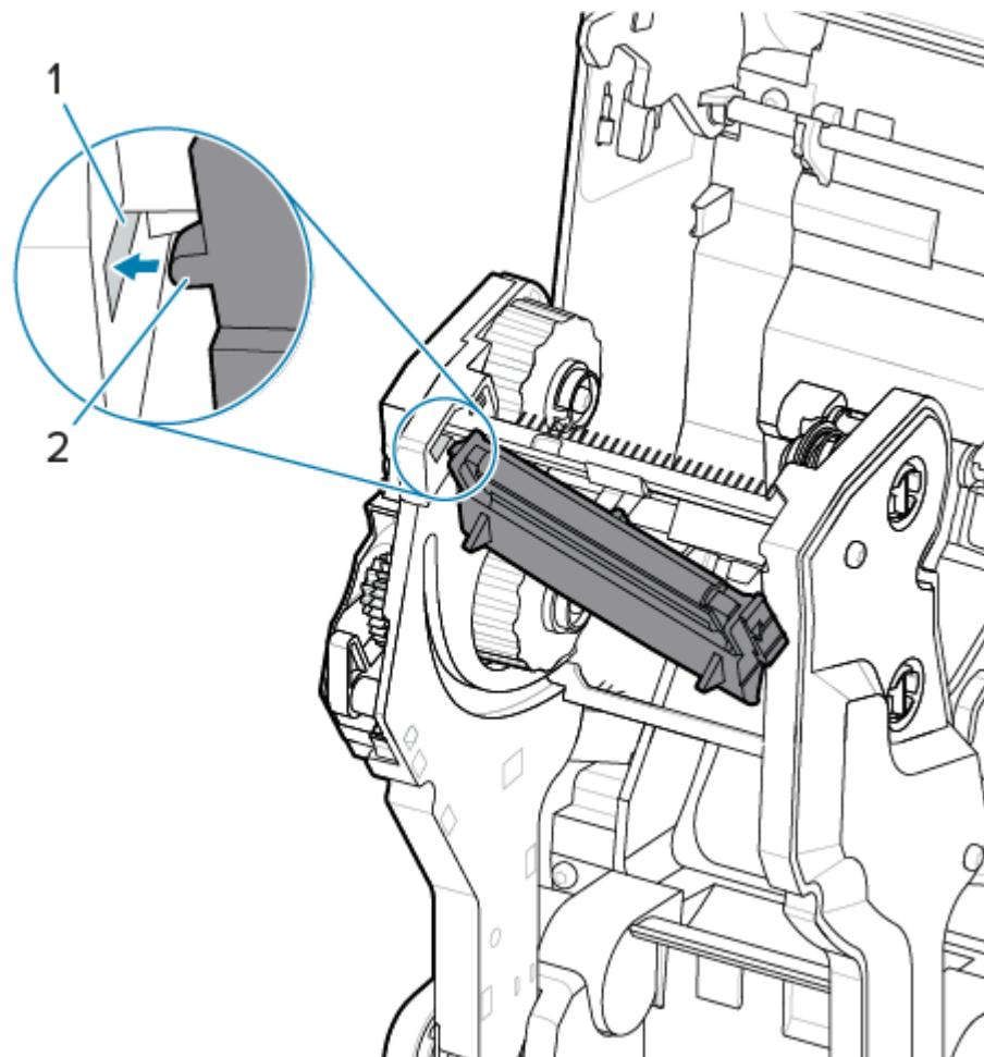
8. Вставьте правую сторону печатающей головки в принтер таким образом, чтобы она защелкнулась и зафиксировалась в принтере.
