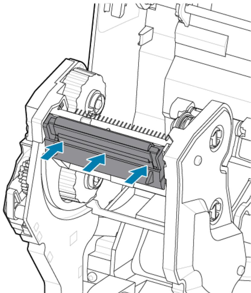
1. Выполните очистку печатающей головки. С помощью нового чистящего карандаша очистите с печатающей головки жирные пятна (отпечатки пальцев) и мусор. Выполняйте очистку печатающей головки от центра к краям. См. [Очистка печатающей головки в принтере ZD411T](#) на странице 122.
