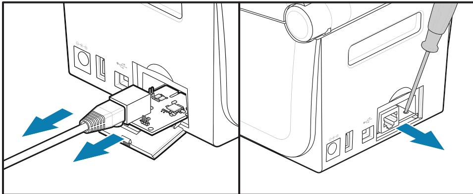
Подцепите плату модуля последовательного порта пальцами, разметочным инструментом или небольшой плоской отверткой, чтобы ее извлечь
