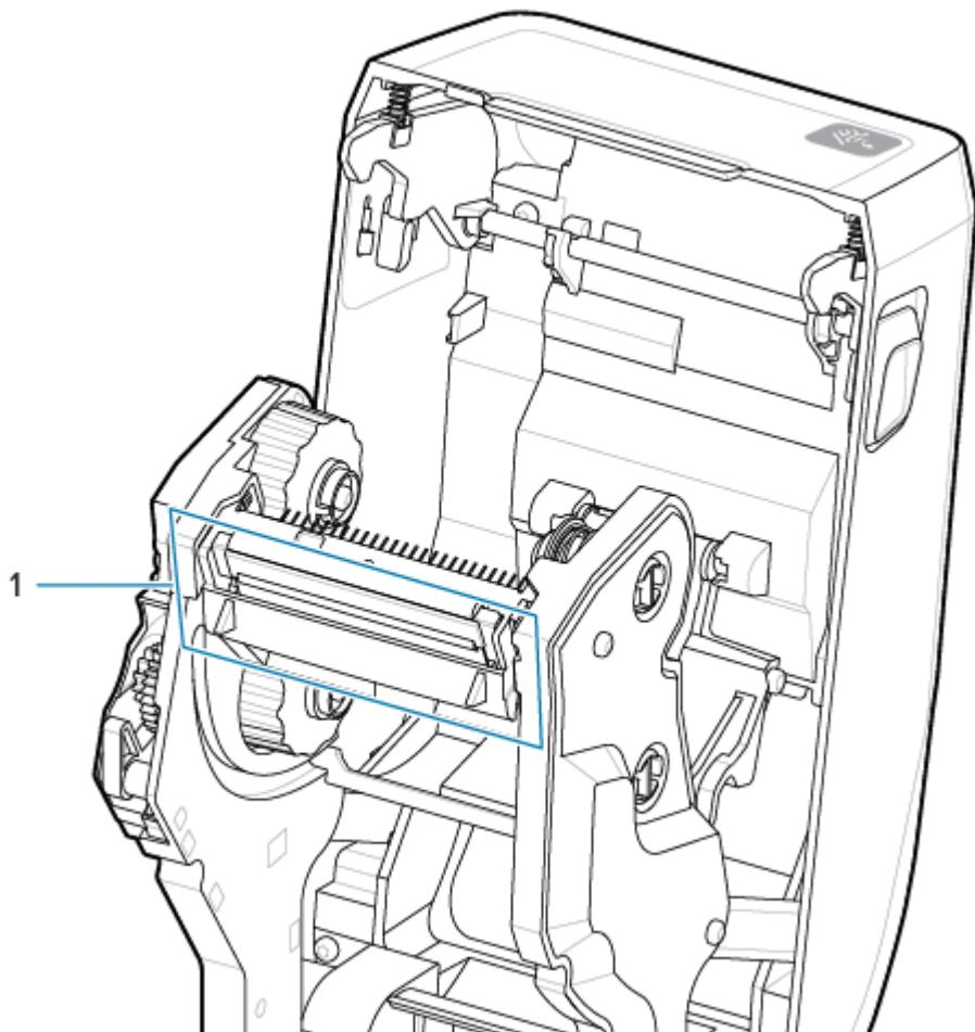
1. Нажмите на фиксатор печатающей головки по направлению к печатающей головке (для наглядности выделено зеленым). Правая сторона печатающей головки отойдет вниз и в сторону от ее блокировочного рычага (1).
