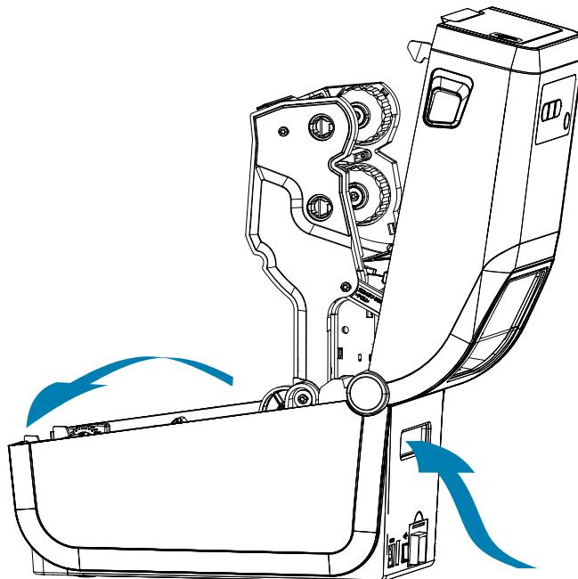
3. Отрегулируйте конечное положение направляющих носителя при помощи защелки серого цвета. Она расположена снаружи левого держателя рулона носителя. Настройте ширину
