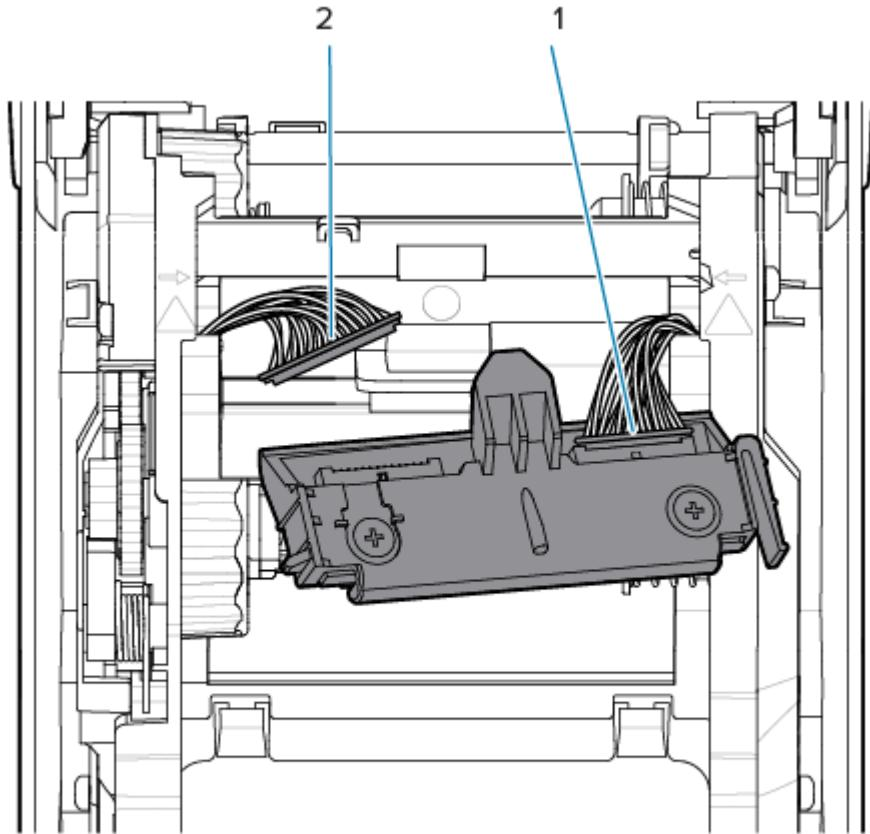
6. Вставьте центральный выступ на узле печатающей головки в центральный паз на монтажном кронштейне головки в каретке для ленты.
