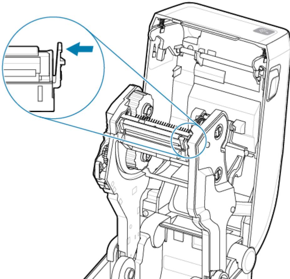
2. Поднимите освободившуюся правую сторону печатающей головки, чтобы она вышла из принтера. Потяните печатающую головку немного вправо, чтобы высвободить ее левую сторону.
