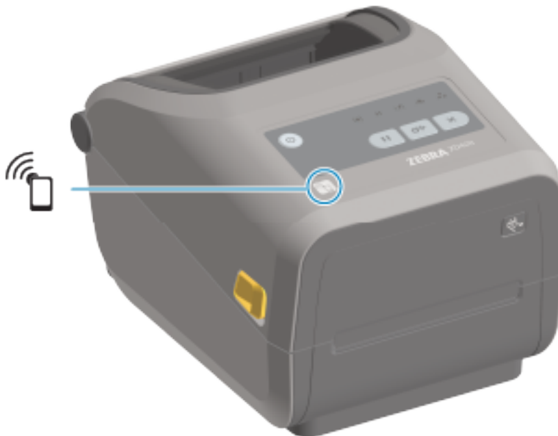
Figura 7 Ubicación táctil de impresión (NFC pasiva)
