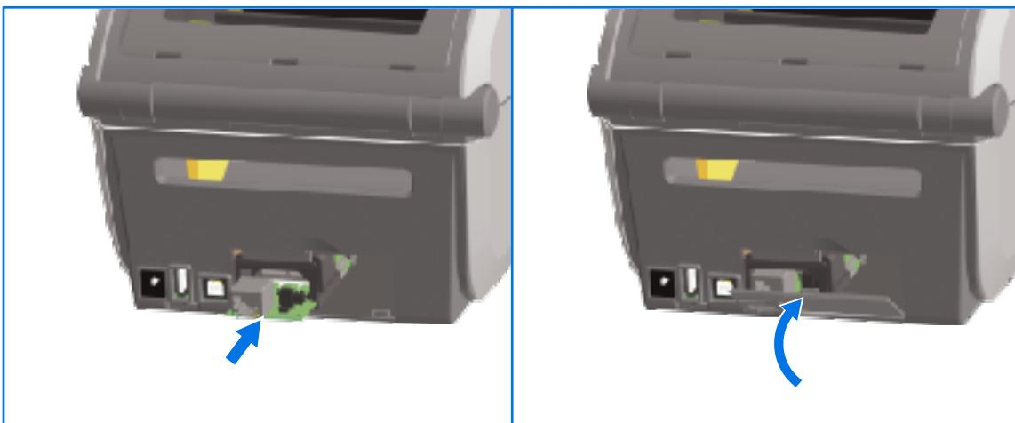
2. Poravnajte dno poklopca vratašaca serijskog priključka s donjim rubom otvora za pristup modulu. Zakrenite vrata prema gore i zatvorite poklopac.
