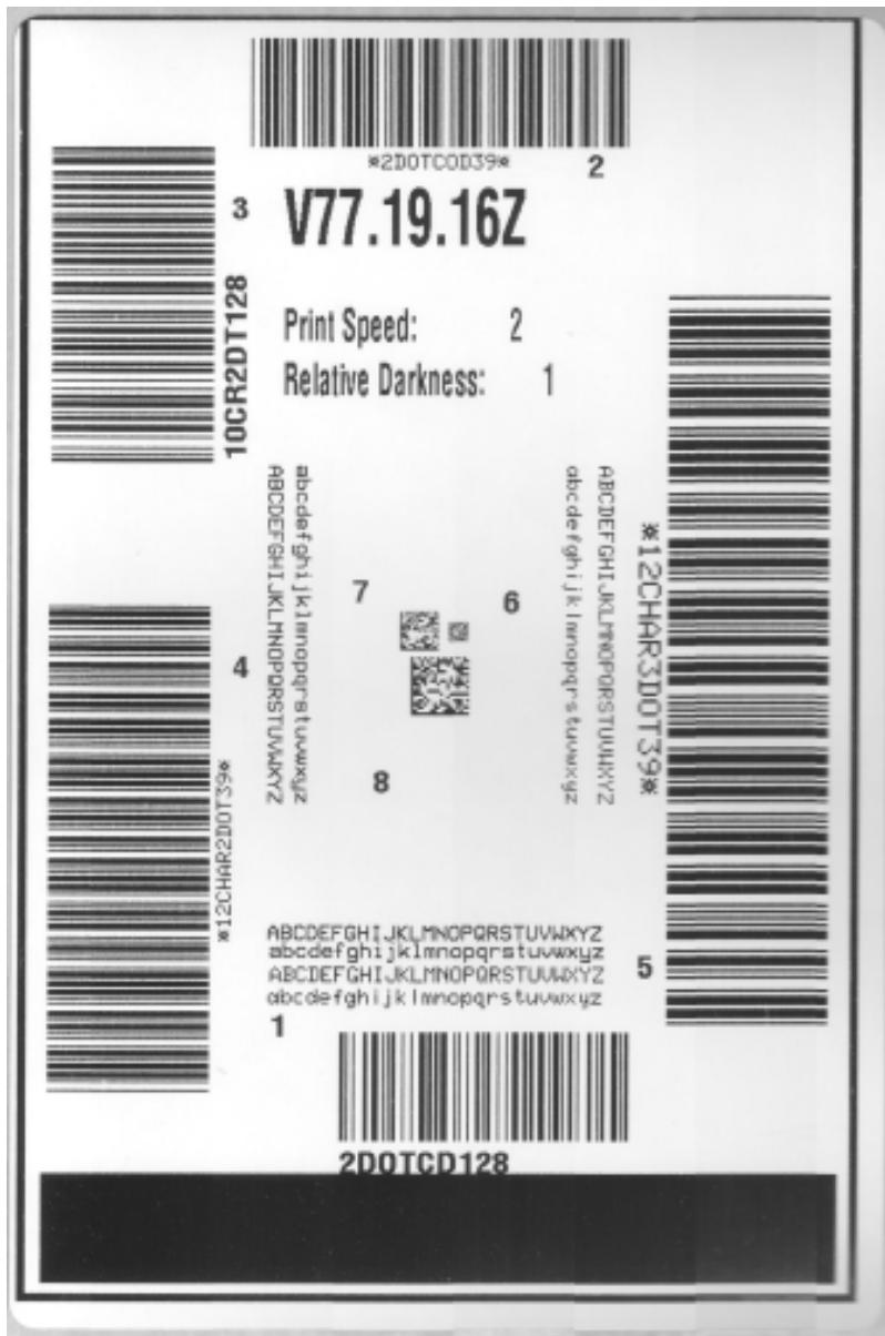
Brzina kojom se ispisuju naljepnice u okviru ovog testiranja kvalitete ispisa ovisi o gustoći točkica na ispisnoj glavi.
