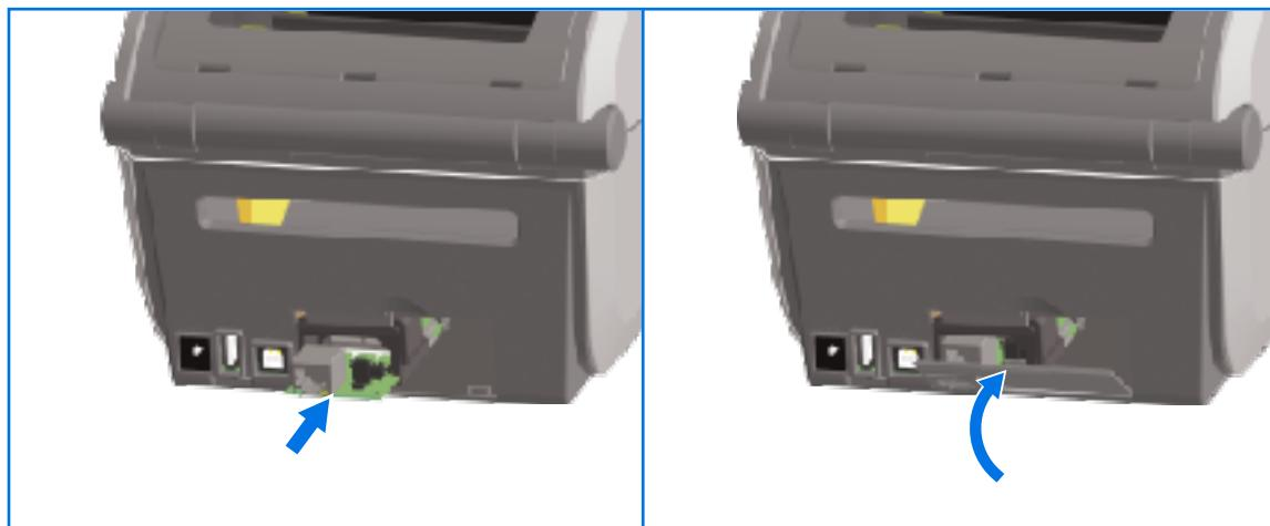
2. Poravnajte dno poklopca vrata Ethernet priključka s donjim rubom otvora za pristup modulu, a zatim povucite vrata prema gore i zatvorite poklopac.
