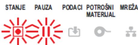
Ispisna glava bila je na kritičnoj temperaturi ili je došlo do prekida napajanja. Pisač isključite tako što ćete **POWER** (Napajanje) zadržati pritisnutim pet sekundi. Pričekajte da se pisač potpuno isključi, a zatim ga uključite. Ako se pisač ne oporavi od ove pogreške, pozovite servisnog tehničara. Ispisna glava nije komponenta koju može servisirati rukovatelj.
