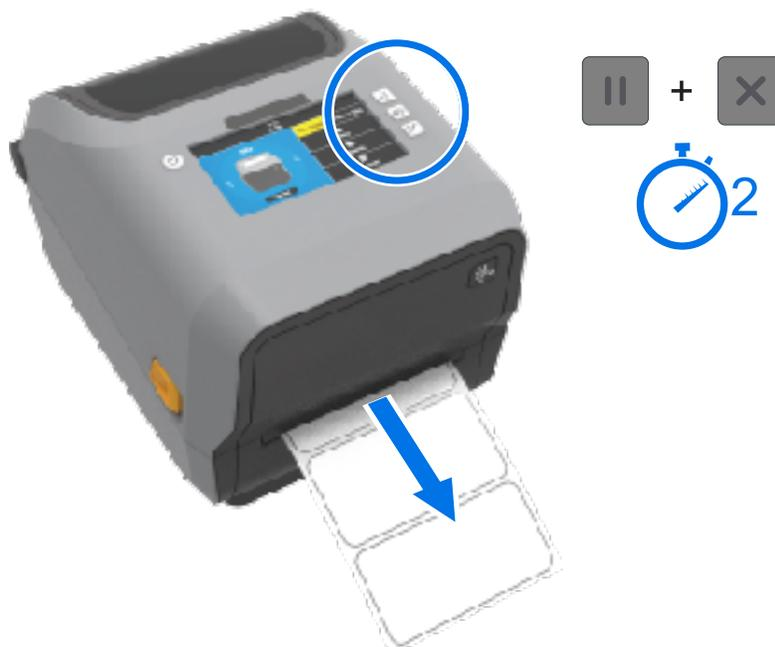
La stampante alimenta e misura alcune etichette e regola i livelli di rilevamento dei supporti. Quando la stampante completa la misurazione, l'indicatore di stato (STATUS [STATO]) diventa di colore verde fisso.
