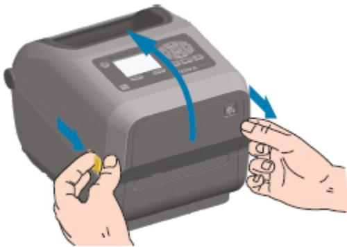
2. Aprire i supporti per il rotolo di supporti. Orientare il rotolo di supporti in modo che la superficie di stampa sia rivolta verso l'alto quando passa sopra il rullo (di avanzamento). Aprire le guide dei supporti
