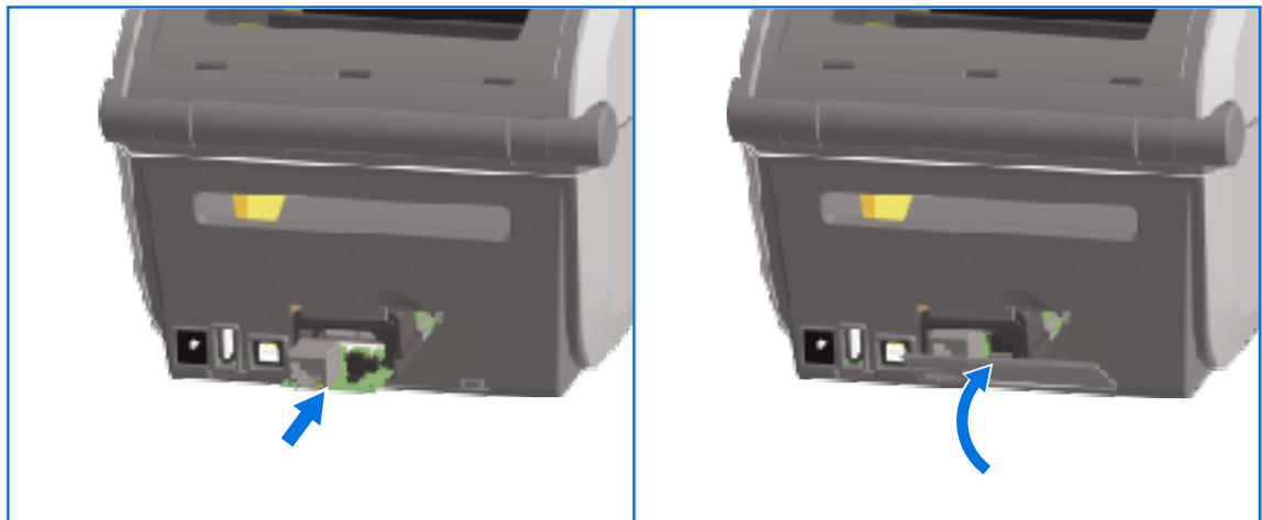
2. Allineare la parte inferiore del coperchio dello sportello della porta Ethernet al bordo inferiore dell'apertura di accesso al modulo, quindi ruotare lo sportello verso l'alto e chiudere il coperchio con uno scatto.
