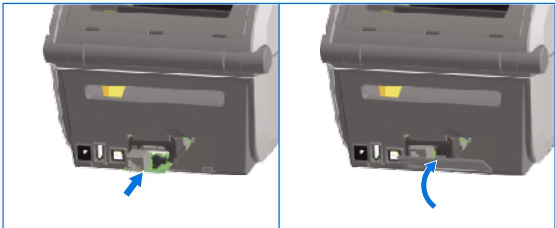
2. Allineare la parte inferiore del coperchio dello sportello della porta seriale al bordo inferiore dell'apertura di accesso al modulo. Ruotare lo sportello verso l'alto e chiuderlo con uno scatto.
