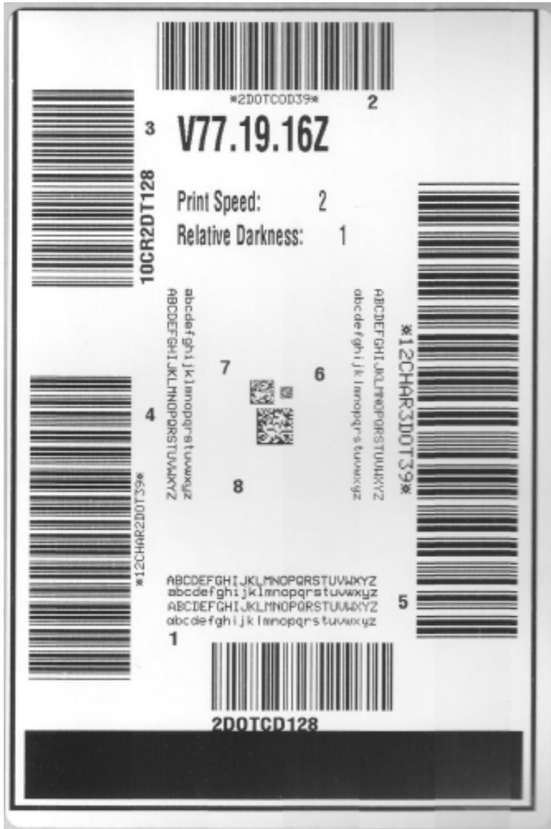
4. Ispezionare le etichette dei prova e determinare quale presenta la migliore qualità di stampa per l'applicazione in uso.
