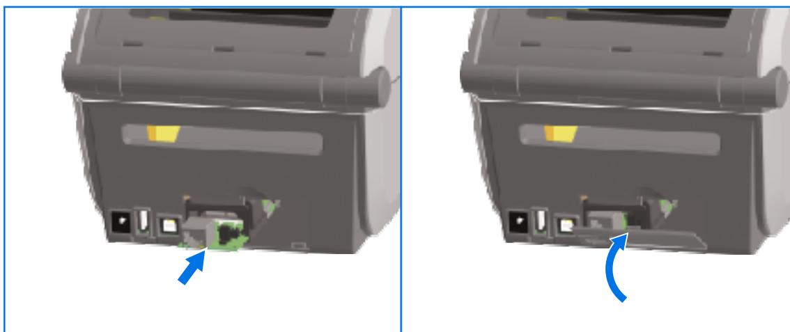
2. シリアルポートのドアカバーの下部を、モジュールアクセス開口部の底部のへりの位置と合わせます。ドアを上持ち上げてカバーをカチッと閉じます。
