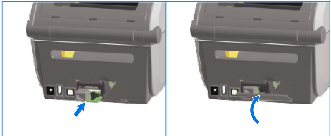
2. イーサネット ポートのドア カバーの下部をモジュール アクセス開口部の下側の縁に合わせ、ドアを上動かして、カバーをカチッと閉じます。
