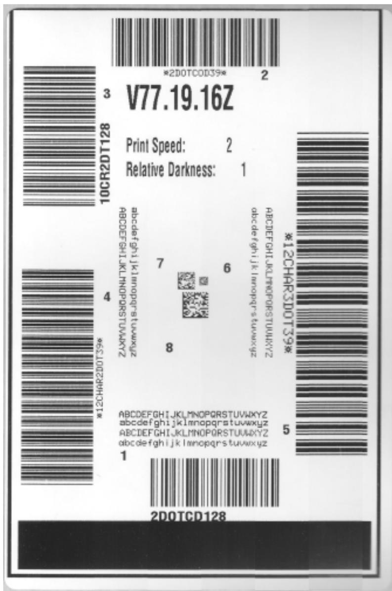
この印刷品質テスト中のラベル印刷速度は、印字ヘッドのドット密度により異なります。
