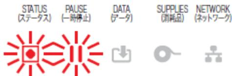
印字ヘッドが限界温度に達したか、電源障害です。[POWER] (電源) を 5 秒間長押しして、プリンタの電源をオフにします。プリンタが完全にシャットダウンするまで待機後、電源をオンにします。プリンタがこのエラーから回復しない場合は、サービス技術者にお問い合わせください。印字ヘッドは、オペレータによる修理が可能な部品ではありません。
