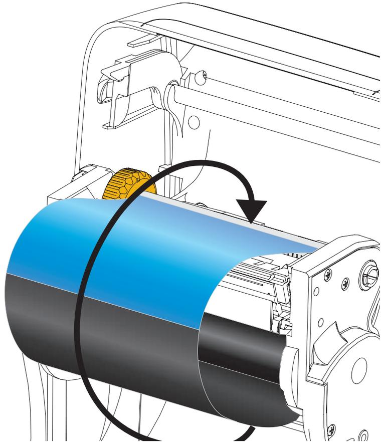
4. Ziehen Sie das Farbband durch Drehen des Einstellrads an der linken Seite der Vorratsspule in Richtung der Druckerrückseite über dem Druckkopf straff.
