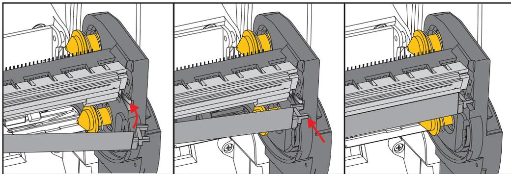
7. Überprüfen Sie, ob der Druckkopf mit etwas Druck nach oben und unten bewegt werden kann und dann an der entsprechenden Position bleibt.
