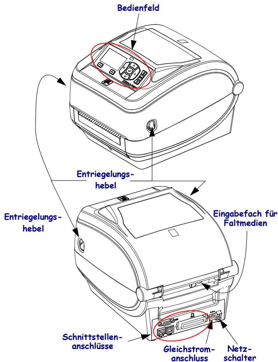
Abbildung 2 • Druckerteile (Fortsetzung)
