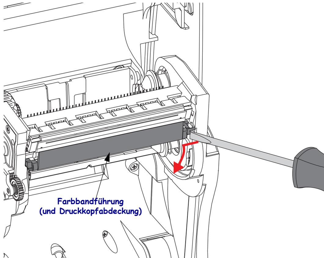
3. Drücken Sie die rechte und dann die linke Arretierung des Druckkopfes nach innen. Verwenden Sie dazu einen stumpfen Gegenstand mit einem Durchmesser zwischen 2,5 und 3,8 mm (0,10 bis 0,15 Zoll). Führen Sie das Werkzeug durch die (runde) Öffnung des Farbbandrahmens zur Arretierung des Druckkopfes. Drücken Sie die Arretierung nach innen, und ziehen Sie den Druckkopfhalter vorsichtig nach unten.
