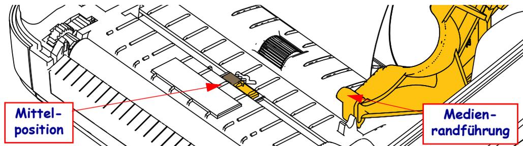
2. Entfernen Sie die ersten 80 mm (3 Zoll) der Etiketten vom Träger. Ziehen Sie den leeren Träger über die Auflagewalze (Antriebswalze) und positionieren Sie die führende Kante des ersten Etiketts unter den Medienführungen.
