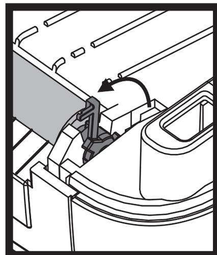
3. Heben Sie die Auflagewalze aus dem unteren Druckerrahmen heraus.
