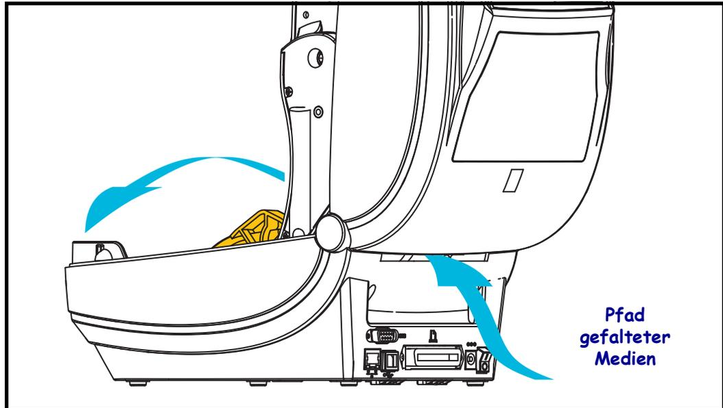
2. Passen Sie die Stoppstellung der Medienführung mithilfe des grünen Einstellrads an. Legen Sie die Stoppstellung mithilfe eines Streifens der gefalteten Medien fest. Wenn Sie das Einstellrad in Ihre Richtung drehen, wird die Öffnung der Medienführung breiter. Durch Drehen des Einstellrads in die andere Richtung wird die Öffnung der Medienführung schmaler.
