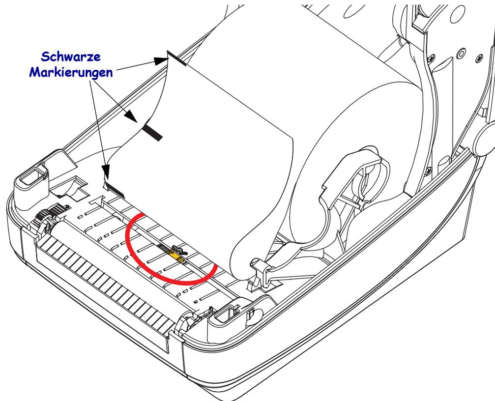
2. Richten Sie den beweglichen Sensor, der standardmäßig in der Mitte positioniert ist, an den schwarzen Markierungen aus. Der Pfeil auf dem beweglichen Sensor sollte am rechten Rand der schwarzen Markierung ausgerichtet sein. Dies gilt für Markierungen oder Aussparungen an beiden Seiten des Druckmediums (in der Abbildung befindet sich die Markierung links).
