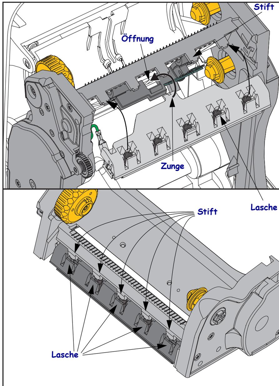
6. Setzen Sie das linke Ende der Farbbandführung in den Farbbandrahmen ein. Setzen Sie das rechte Ende der Farbbandführung so in die Öffnung ein, dass die Farbbandführung einrastet.
