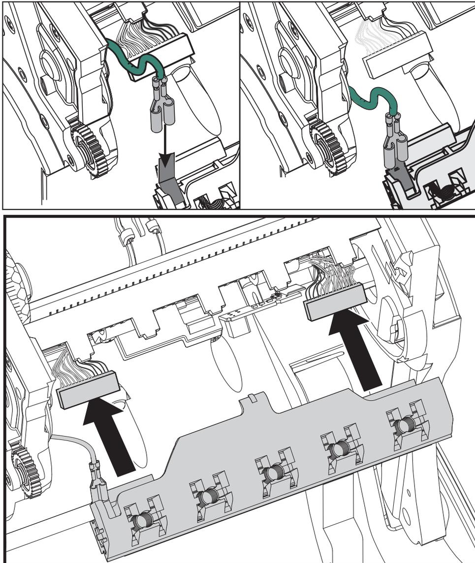
5. Führen Sie die Zunge des Druckkopfhalters in die Öffnung der Farbbandeinheit. Positionieren Sie die fünf Druckkopflaschen gegenüber den fünf Stiften, und lassen Sie den Druckkopf im Farbbandrahmen einrasten.
