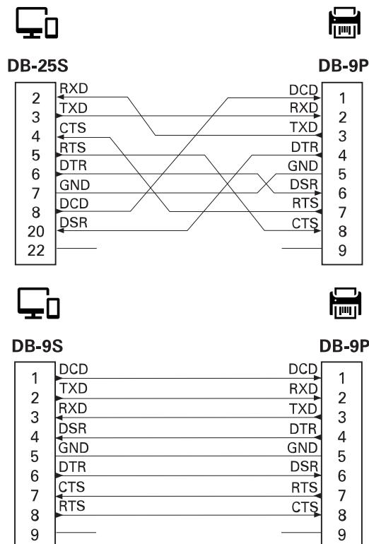
Povezivanje s uređajima DCE – kada se pisač s podatkovnom komunikacijskom opremom (DCE), kao što je modem, povezuje putem sučelja RS-232, treba upotrijebiti STANDARDNI (jednosmјerni) kabel za sučelje RS-232.
