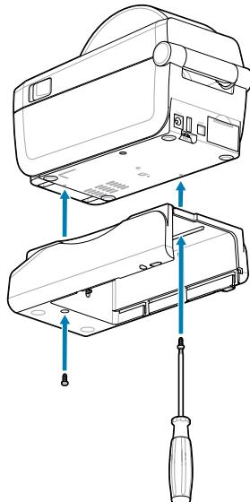
2. Baterijsku bazu za pisač pričvrstite s dva isporučena vijka. Zategnite vijke šesterokutnim ključem°T10. Baterija je spremna za instalaciju u baterijsku bazu pisača.
