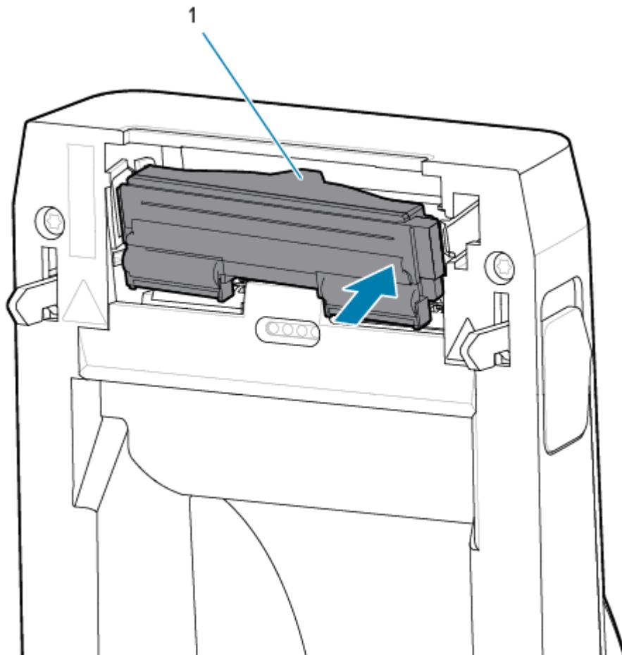
9. 圧力をかけると、印字ヘッドが上下に自由に移動し、圧力を解除するとロックされたままになることを確認します。
