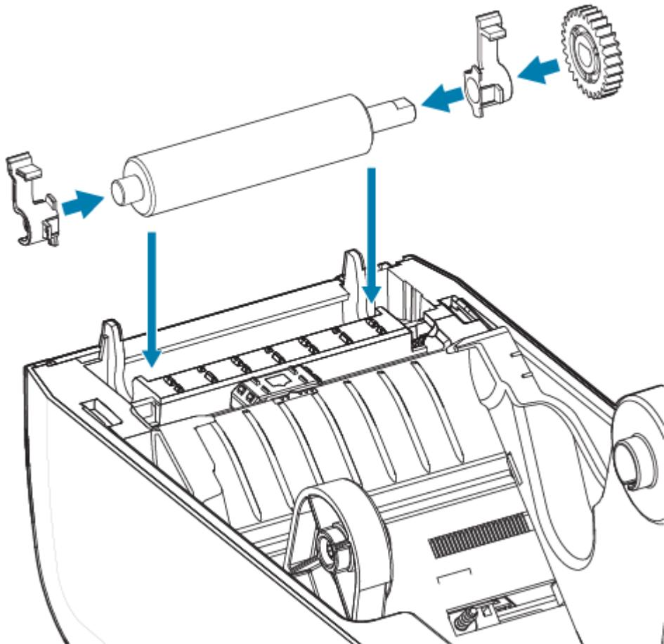
8. プラテンを左側のギアに合わせて、プリンタの底のフレームに下ろします。
