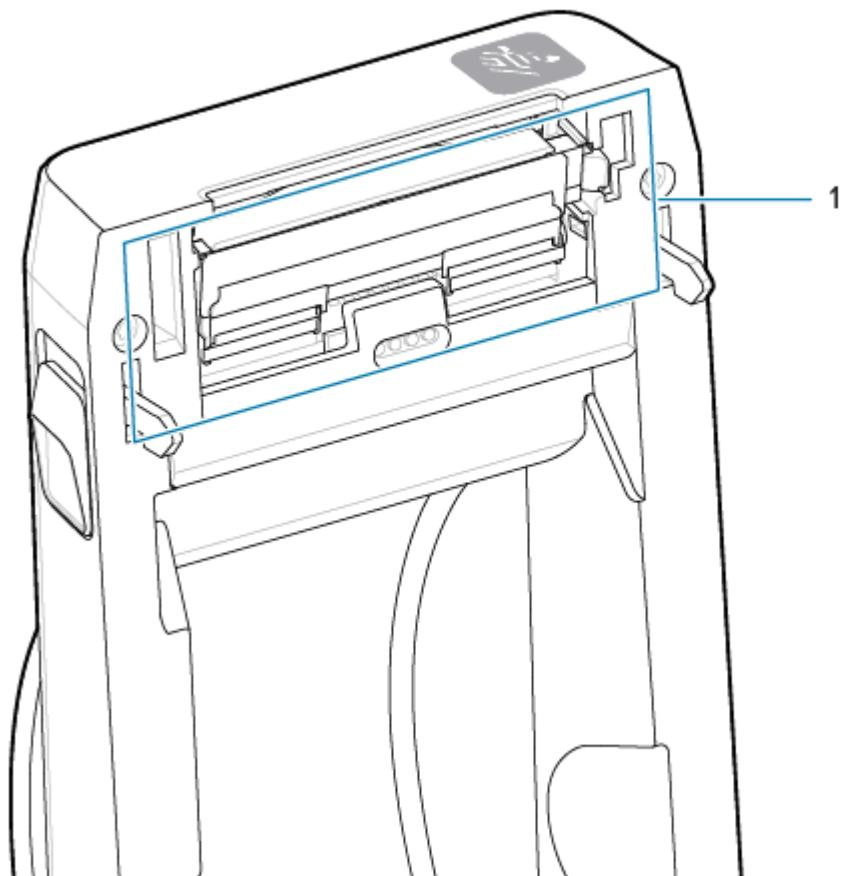
1. 印字ヘッド リリース ラッチを、印字ヘッドの外側に向けて押します。印字ヘッドの右側が自由になります。
