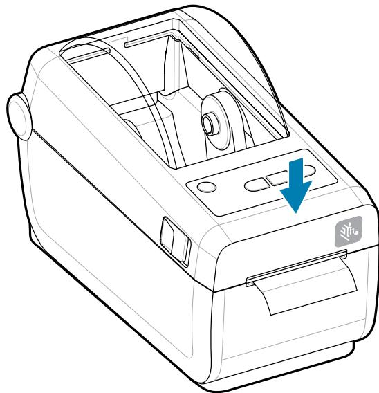
新しい用紙に合わせてプリンタをキャリブレーションするプリンタのセンサーは、ラベル、ライナーおよびラベル間の距離を検知して正常に動作するように調整する必要があります。
