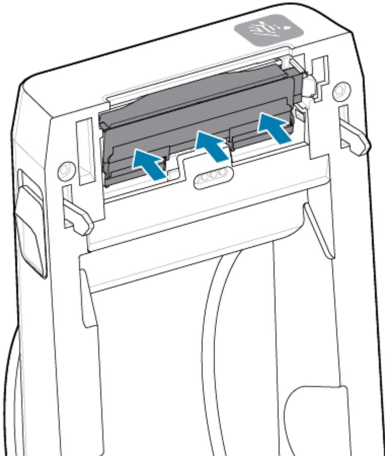
1. 印字ヘッドをクリーニングします。新しいペンを使用して、人の油脂(指紋など)やごみを印字ヘッドから拭き取ります。印字ヘッドの中央から外に向かってクリーニングします。[ZD610 印字ヘッドのクリーニング](#) (122ページ) を参照してください。
