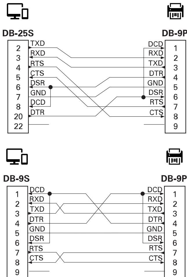
DTE デバイスへの相互接続 - プリンタは、データ端末装置 (DTE) として構成されています。プリンタを他の DTE デバイス (パソコンのシリアルポートなど) に接続するには、RS-232 ナル モデム (クロスオーバー) ケーブルを使います。
