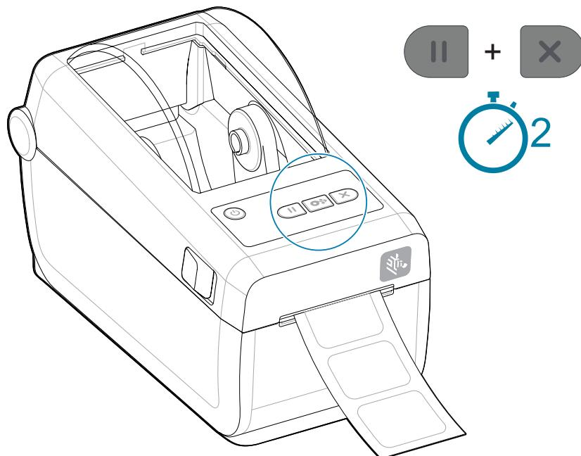
プリンタは、数枚のラベルを測定して用紙検知レベルを調整します。
