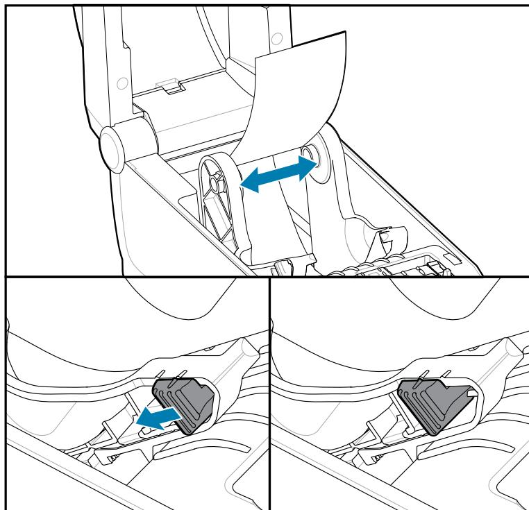
4. プリンタの背面にあるスロットに通して用紙を挿入し、用紙ガイドとロールホルダーの間に用紙を位置決めします。
