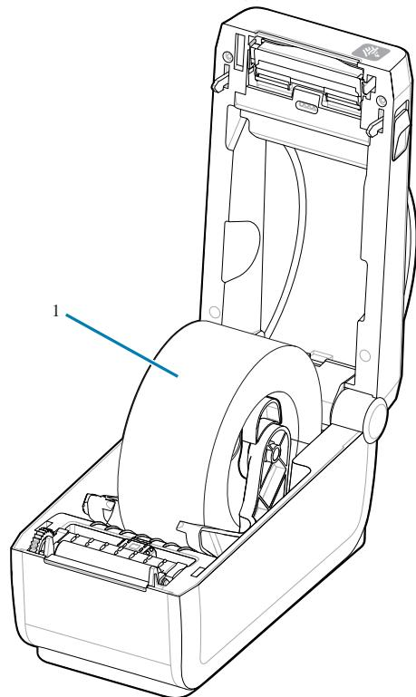
内部コアが38.1mm（1.5インチ）のラベルロールを用紙巻芯アダプタに取り付けた例
