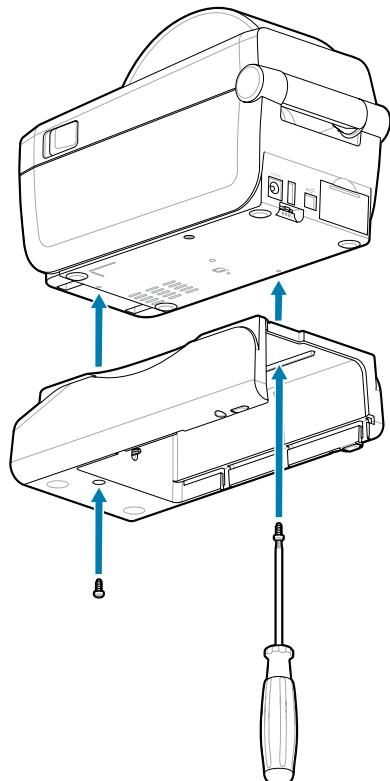
2. 付属の 2 つのネジを使用して、バッテリ ベースをプリンタに取り付けます。#10 ヘクサロビュラ レンチを使用してネジを締めます。
