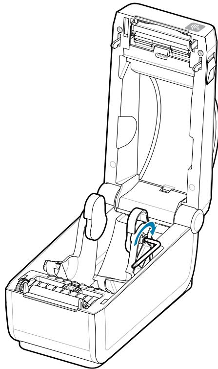
3. ねじを使用してアダプタをロールホルダーに取り付けます。
