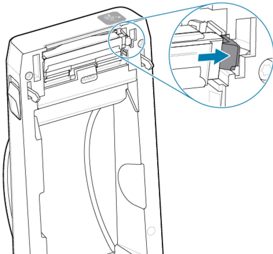
2. 印字ヘッドの自由になった右側をスイングさせてプリンタから外します。右側に少し引き出すようにして、印字ヘッドの左側を外します。印字ヘッドを引き出して上部カバーから取り外し、印字ヘッド
