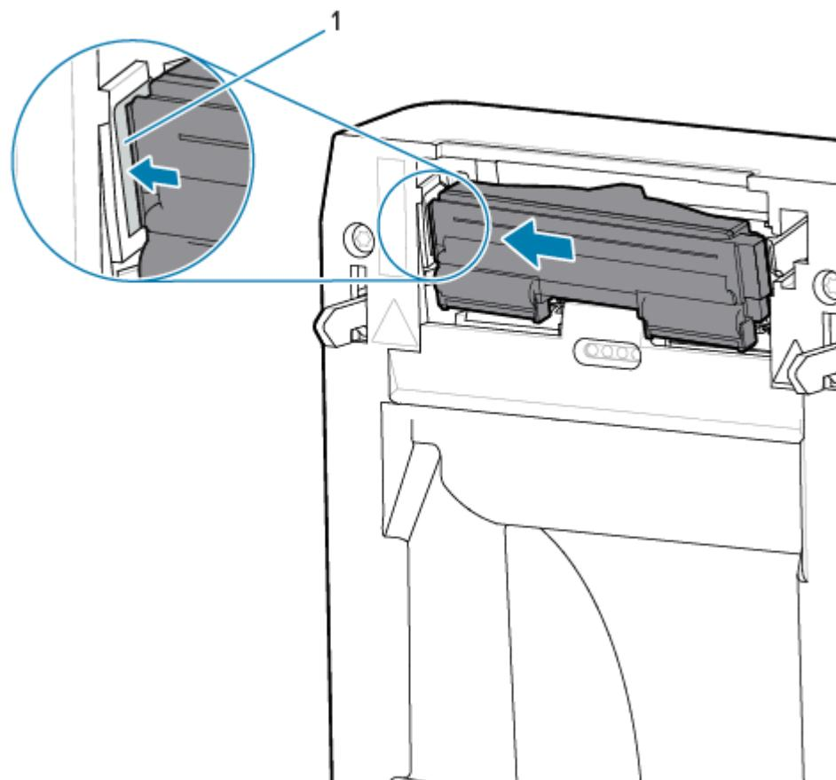
8. 印字ヘッドの背面にあるスプリング ワイヤ ノッチ (1) をスプリング ワイヤに合わせます。止め金で印字ヘッドの右側がプリンタにロックされるまで、印字ヘッドの右側をプリンタに押します。
