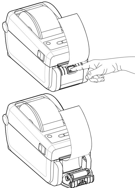
3. ディスペンサ ドアとプリンタ本体の間にラベル ライナーを挿入します。
