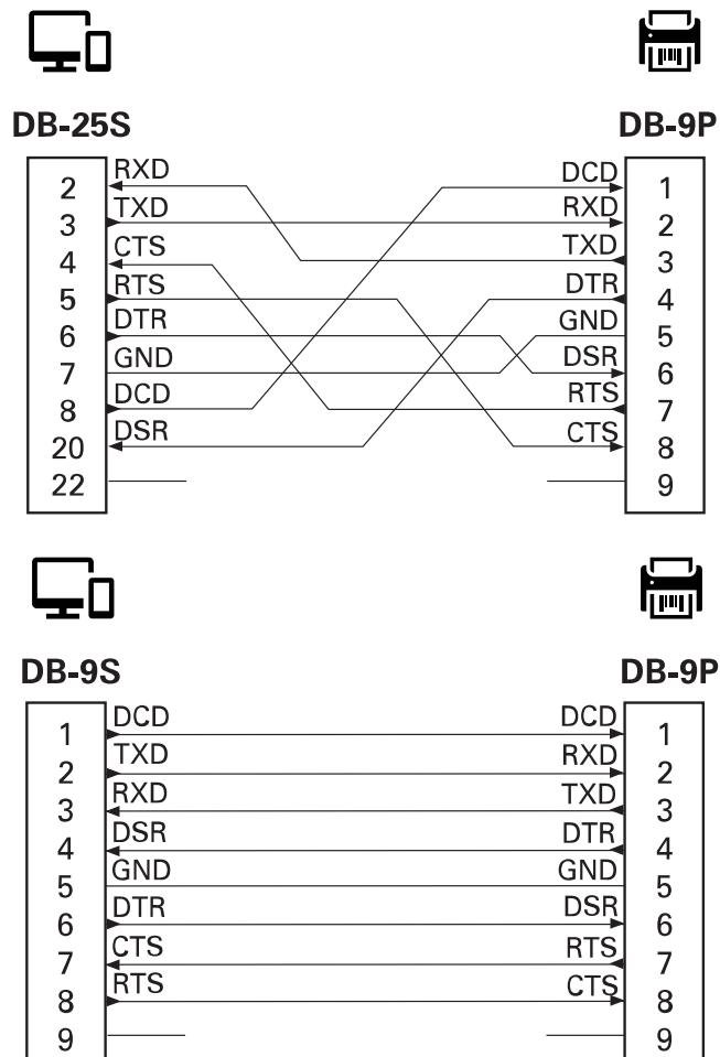
DCE デバイスの交互接続 - プリンタをその RS-232 インタフェースでモデムなどのデータ通信装置 (DCE) に接続する場合は、標準 RS-232 (ストレートスルー) インタフェース ケーブルを使用する必要があります。
