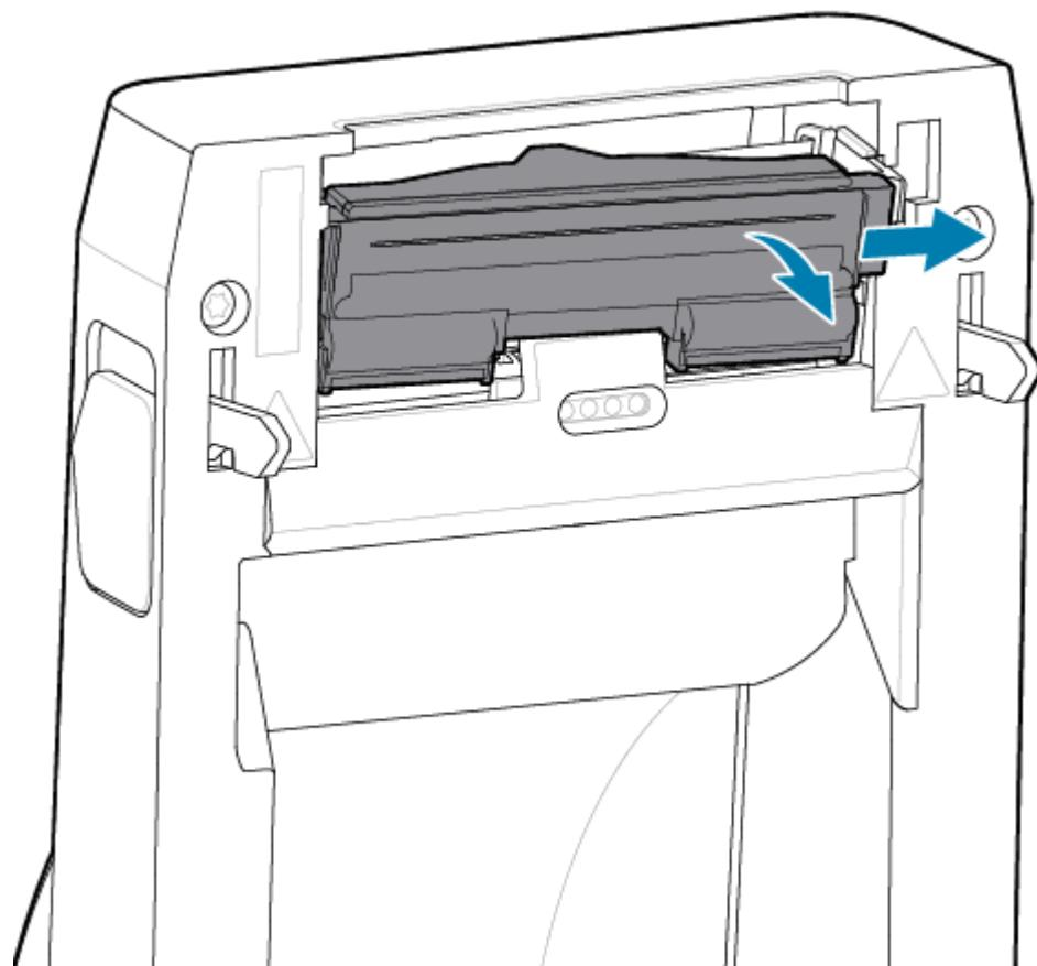
3. 印字ヘッド (2) から、2組の印字ヘッド ケーブル コネクタ (1) をゆっくり確実に引き抜きます。印字ヘッドからアース線 (3) を引き抜きます。
