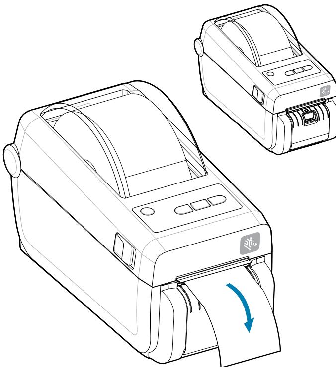
2. ライナーをプリンタの上部に持ち上げます。ディスペンサ ドアの中央にある金色のラッチをプリンタから引くとドアが開きます。
