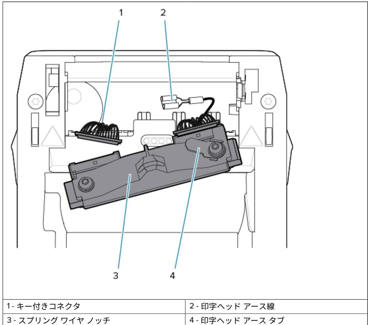
7. 印字ヘッドアセンブリの左側をプリンタの左側にある、赤色で強調表示された窪んだスロット(1)に挿入します。
