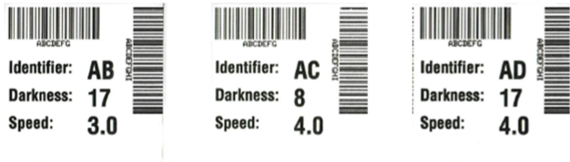
Рисунок 6 Печать тестового образца для проверки качества печати
