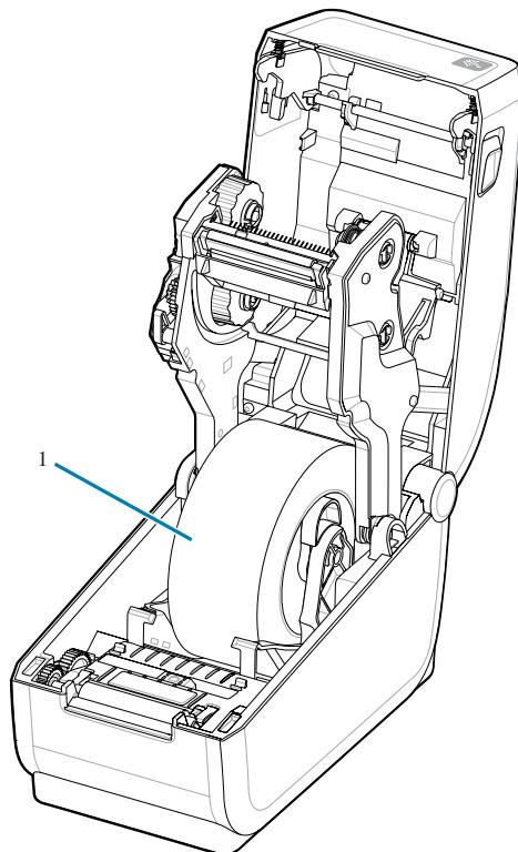
放置在转接器上的标签卷 (1) 的示例。
