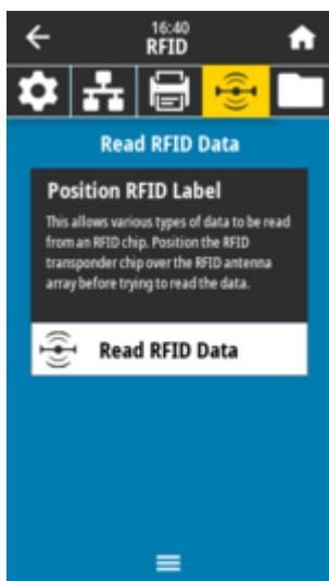
要读取并显示 RFID 标签中存储的信息：
