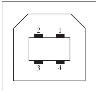
**布线 – USB B 型连接器, 用于连接打印机或设备**
