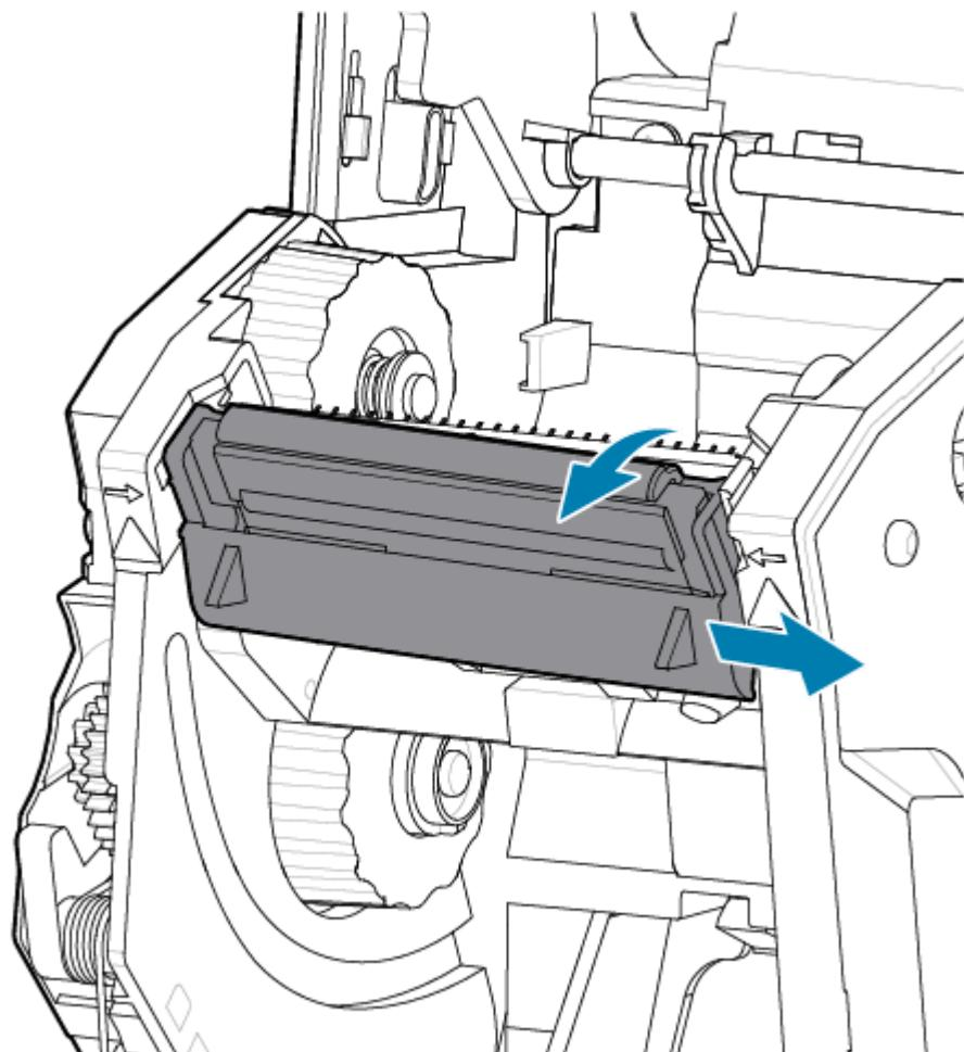
3. 小心地将两个打印头电缆束连接器从打印头上用力拉下。
