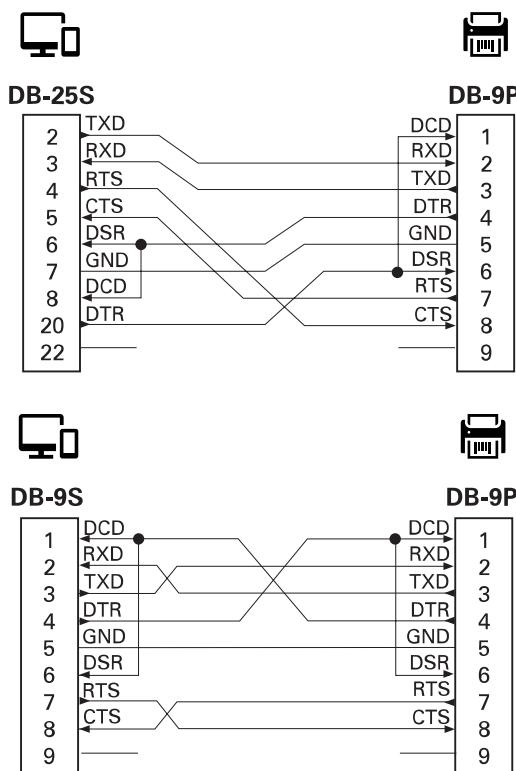
互连到 DTE 设备 — 将打印机配置为数据终端设备 (DTE)。要将打印机连接到其他 DTE 设备（例如个人电脑串行端口），可使用 RS-232 非调制解调器（跨接）电缆。
