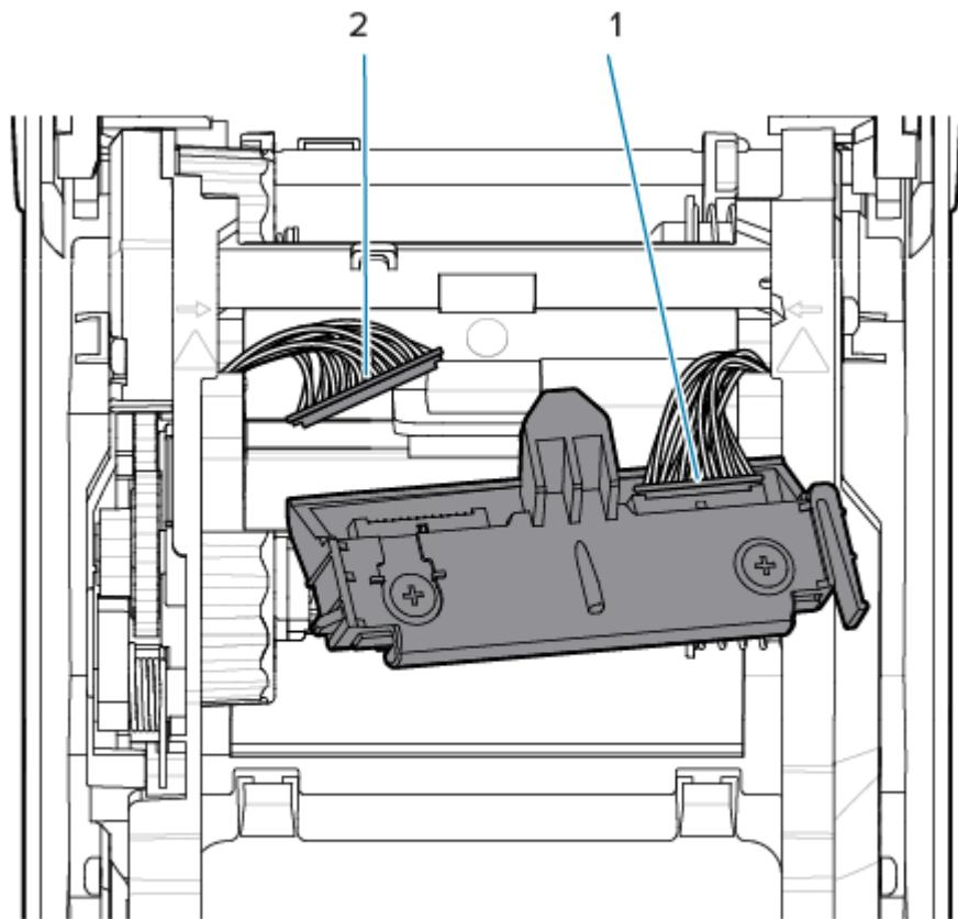
6. 将打印头总成上的中心翼片插入色带夹中打印头安装支架上的中心槽中。
