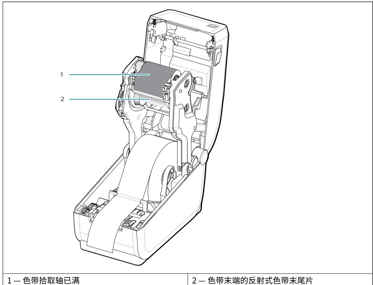
3. 取下拾取轴上的旧色带卷并妥善处置。现在让空的底部供应色带芯保持面向色带夹的底部/背面。
