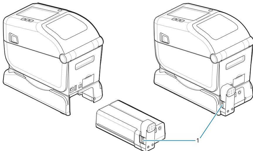
3. 将打印机的电源接到电池，把电池从关闭模式唤醒并开始其初次充电。
