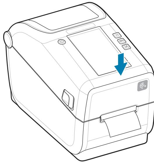
针对新介质校准打印机。打印机的传感器需经过调节，以便感应标签、背衬以及标签间的距离，之后才能正常操作。
