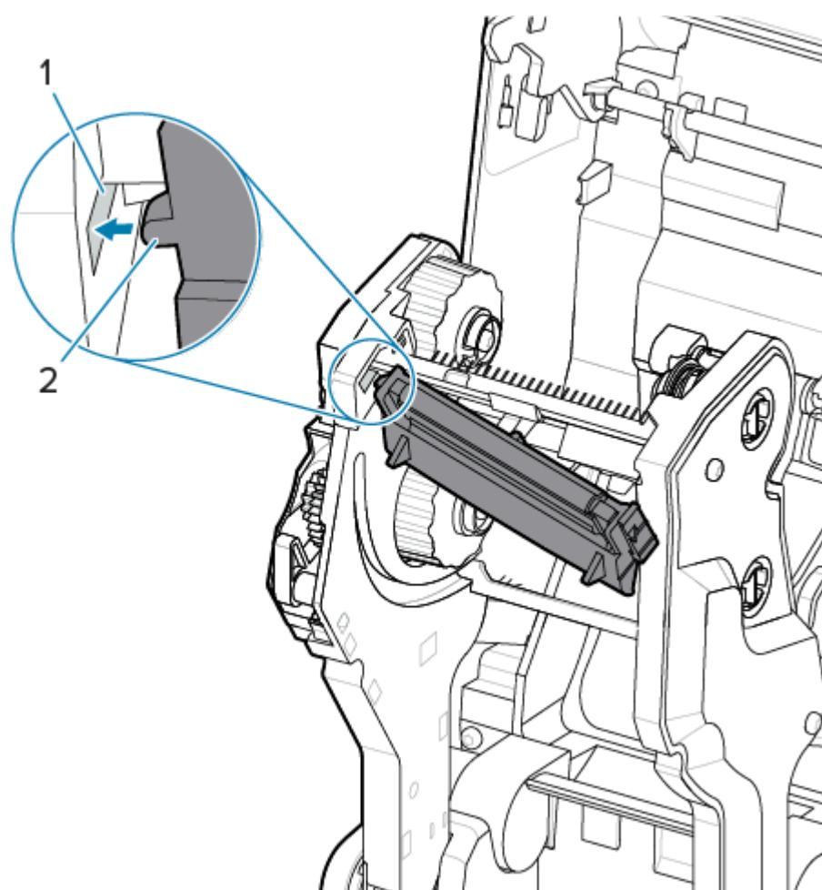
8. 将打印头右侧推入打印机，直到锁片将打印头右侧锁入打印机。
