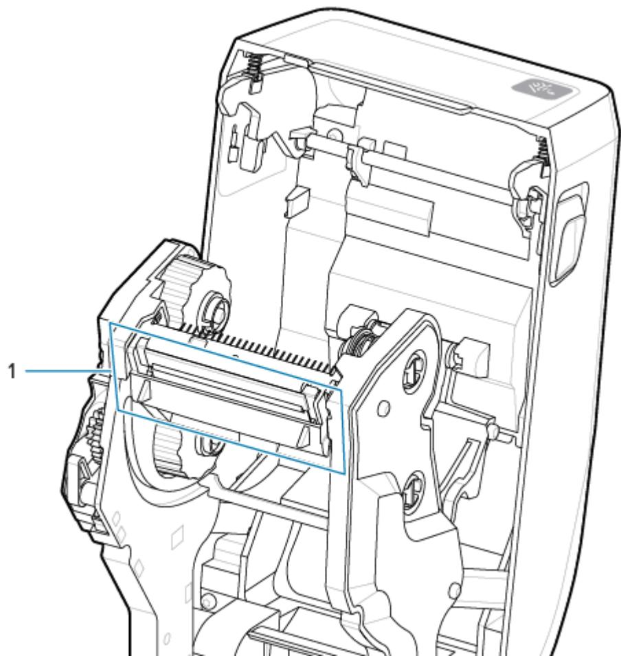
1. 将打印头的松开锁片推向打印头方向（绿色所示）。打印头右侧向下松开并脱离打印头锁臂 (1)。
