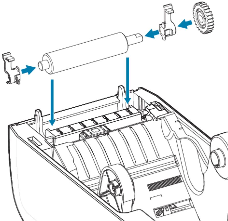
8. 将打印辊与齿轮靠左侧对齐，然后将其向下放入打印机底部支架。
