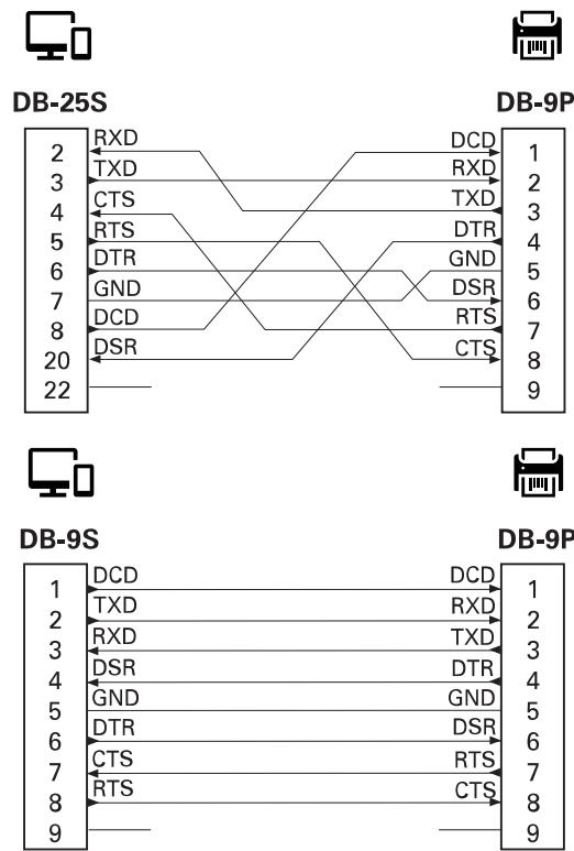
互连到 DCE 设备 — 在通过打印机的 RS-232 接口将打印机连接到调制解调器等数据通信设备 (DCE) 时，必须使用标准的 RS-232（直通）接口。
