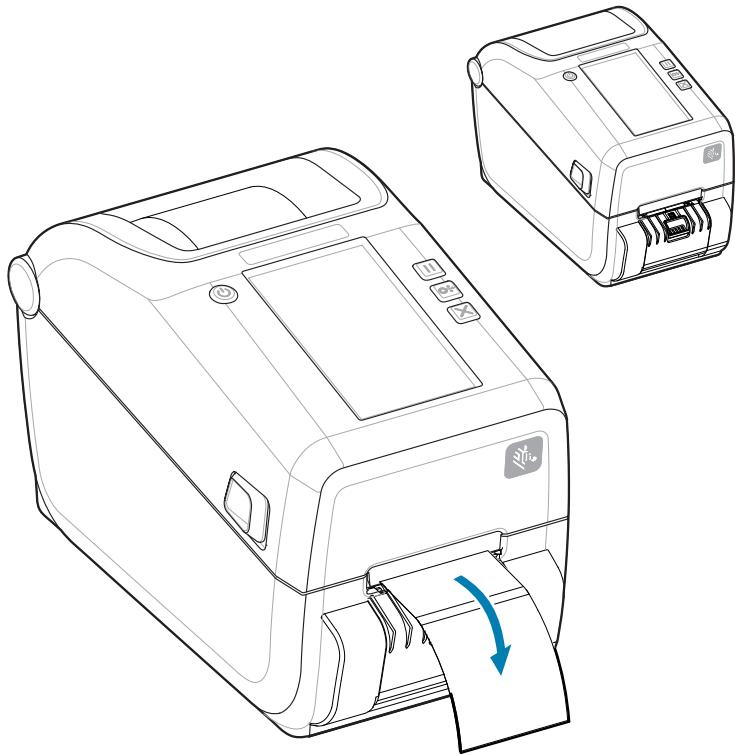
2. 将背衬提至打印机顶部。将分送器盖中心的金色锁片从打印机上拉开，即可打开盖子。
