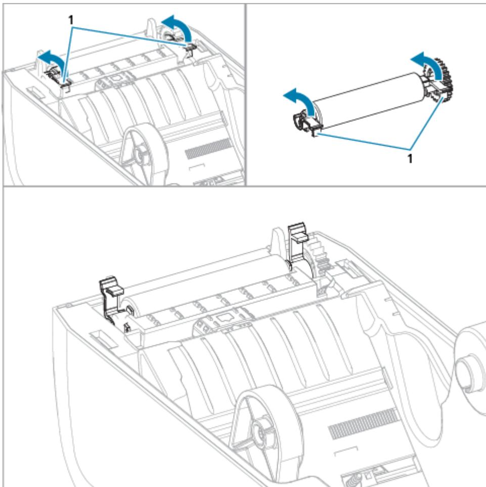
3. 使用轴承臂 (1) 将打印辊从打印机的下机架中提出。
