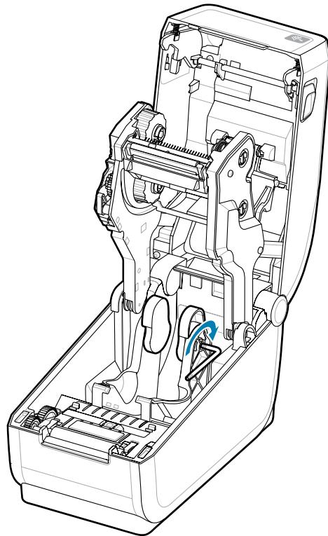
3. 用螺钉将转接器连接到介质卷支架。
