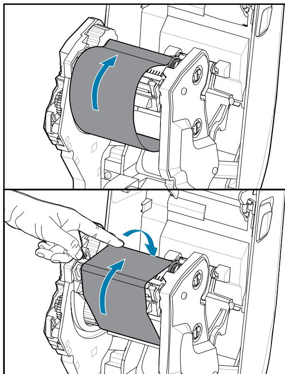
3. 将色带连接到色带拾取芯。将胶条粘在新色带卷上，也可以使用薄胶带。对准色带，让其平直卷绕在色带芯上。
