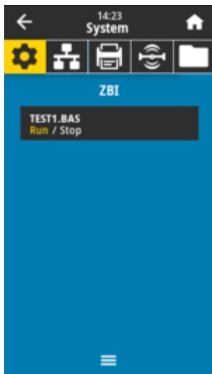
某个程序运行后，打印机将仅列出该程序。轻触 **Stop**（停止，突出显示为白色）可结束该程序。
