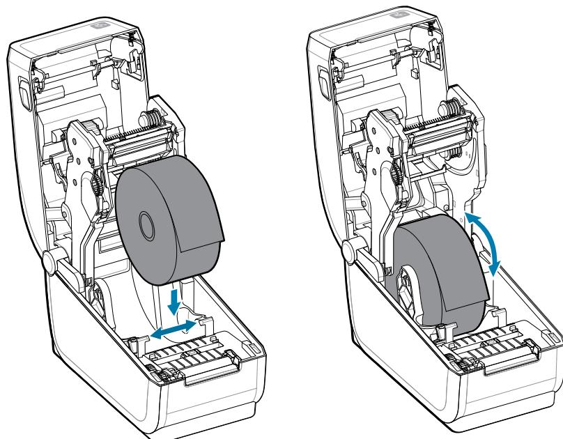
3. 确保介质卷能够自由转动。禁止将介质卷放入介质仓底部。
