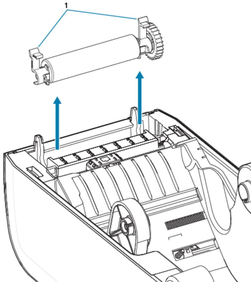
4. 滑动齿轮和两个轴承，使其脱离打印辊轴。
