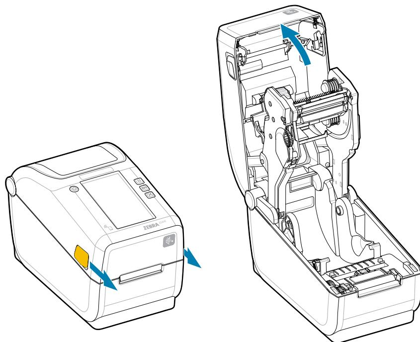
2. 将介质卷支架分开，并将介质卷装入打印机。
