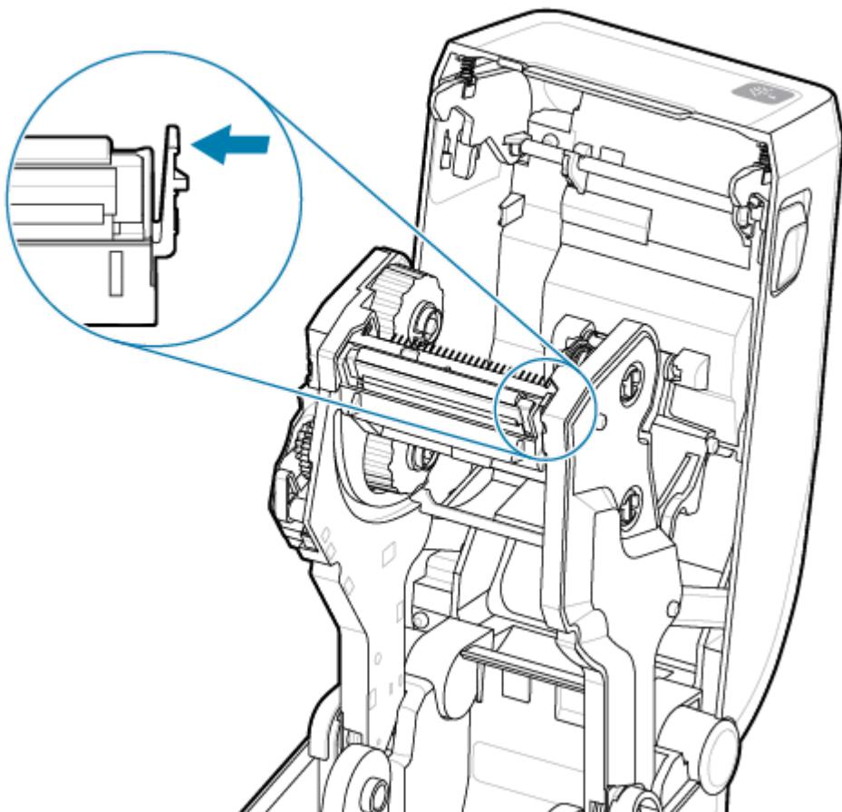
2. 来回摆动松开的打印头右侧，将其拉出打印机。稍微向右侧拉动，拉出打印头左侧。将打印头轻轻向下拉，使其脱离入色带夹，以便露出其连接电缆。
