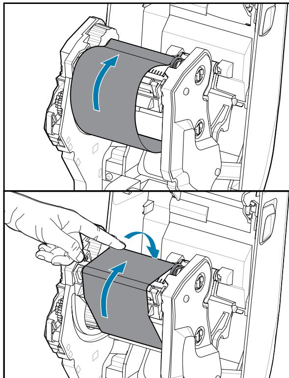
4. 旋转色带拾取轮毂，使顶部向后移动，以收紧色带的松弛部分。旋转轮毂可帮助将拾取色带位置与色带供应辊精确对准。色带引头应被色带完全覆盖。
