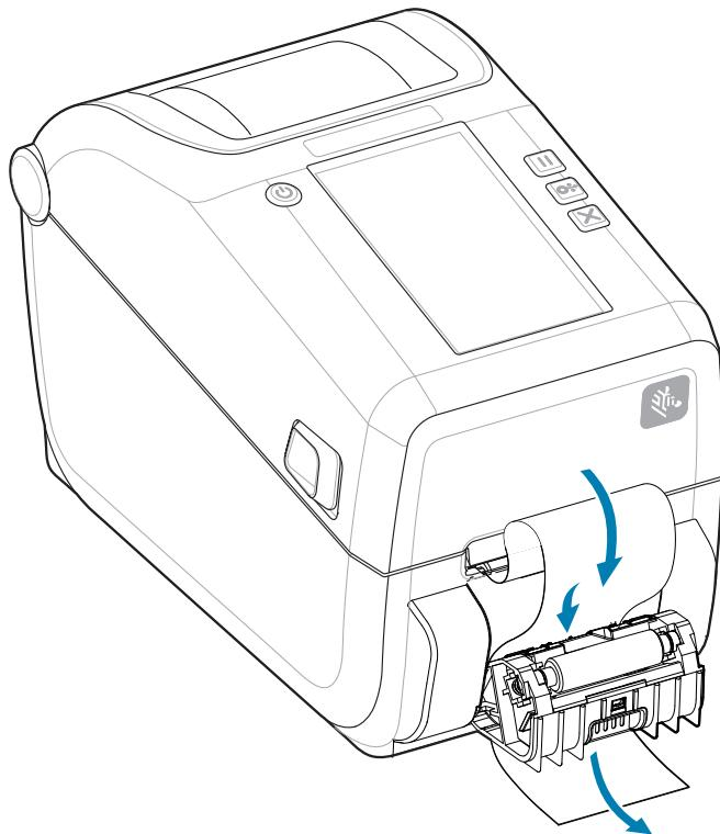
4. 关闭分送器盖，同时拉紧标签背衬的末端。
