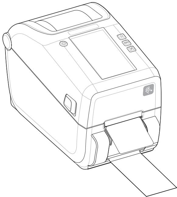
6. 执行打印作业过程中，打印机将背衬剥离，送入单张标签。从打印机上取下标签，让打印机继续打印下一张标签。
