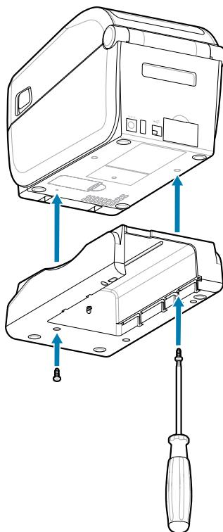
2. 使用提供的两颗螺钉将电池底座连接到打印机。使用 10 号六角扳手拧紧螺钉。
