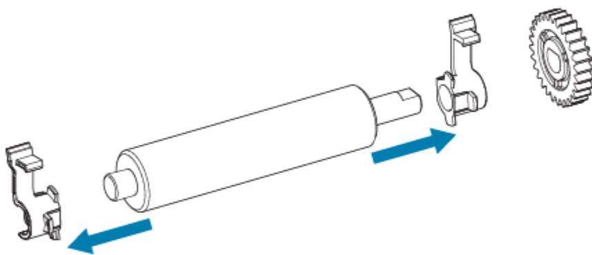
5. 仅清洁 — 使用蘸有酒精的棉签清洁打印辊。从中间向外侧清洁。重复执行此过程，直到打印辊表面已彻底清洁干净。如果粘胶堆积很多或标签堵塞，请用新棉签重复此操作以清除残留污染物，因为初始清洁可能会减少，但不能完全清除粘胶和油渍。
