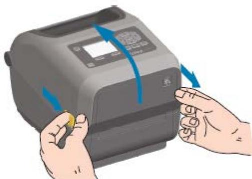
2. Abra los soportes para rollo de medios. Oriente el rollo de medios de modo que la superficie de impresión quede hacia arriba cuando pase sobre el rodillo (de accionamiento) de la platina. Tire de las guías de medios para abrirlas con la mano libre, coloque el rollo de medios en los soportes de rollo y
