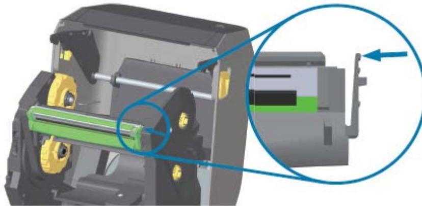
El cabezal de impresión del lado derecho se libera hacia abajo y en dirección contraria al brazo del actuador del cabezal de impresión.
