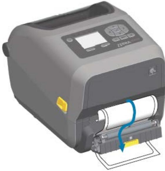
4. Cierre la tapa del dispensador mientras tira del extremo del revestimiento de la etiqueta firmemente.
