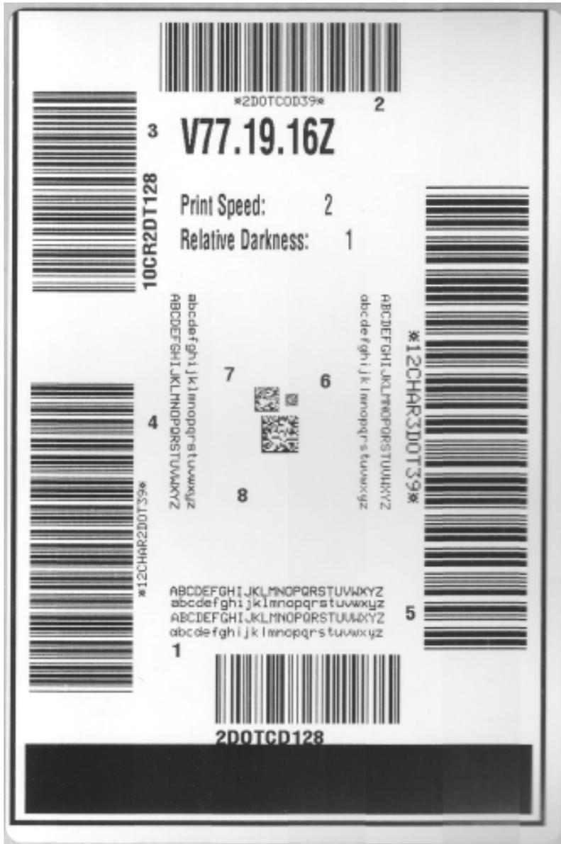
4. Inspeccione las etiquetas de prueba y determine cuál tiene la mejor calidad de impresión para la aplicación.
