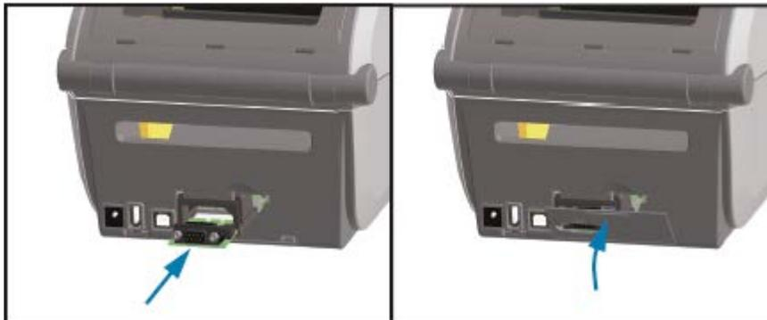
2. Alinee la parte inferior de la cubierta de la tapa del puerto serial con el borde inferior de la abertura de acceso del módulo. Gire la tapa hacia arriba y fije la cubierta para cerrarla.
