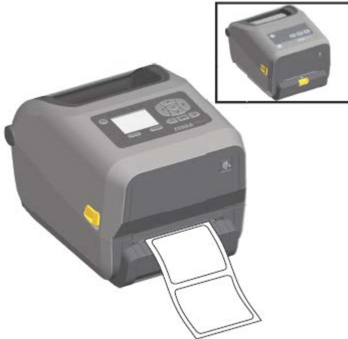
2. Levante el revestimiento sobre la parte superior de la impresora. Tire del pestillo dorado situado en el centro de la tapa del dispensador hacia fuera de la impresora y esta se abrirá.
