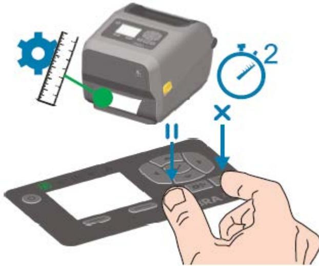
La impresora mide algunas etiquetas y ajusta los niveles de detección de medios. Cuando haya finalizado la medición, el indicador de ESTADO se pone en verde fijo.
