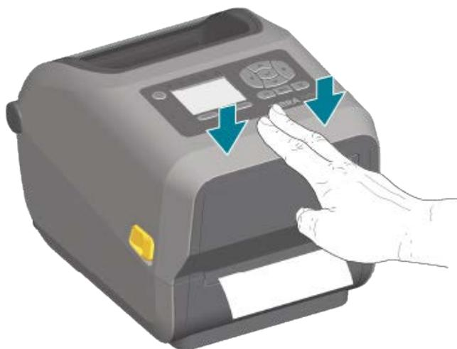
Es posible que deba calibrar la impresora en función de los medios. (Consulte [Ejecución de una calibración de medios SmartCal](#) en la página 146). Los sensores de la impresora deben ajustarse para que detecten la etiqueta, el revestimiento y la distancia entre las etiquetas para funcionar de forma correcta. Cuando vuelva a cargar los mismos medios (tamaño, proveedor y lote), simplemente puede presionar el botón **FEED (AVANCE)** una vez a fin de preparar los medios para la impresión.
