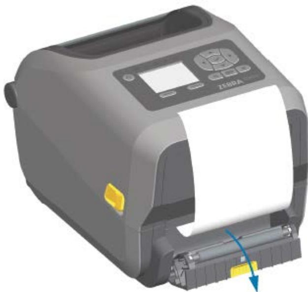
3. Insérez la doublure d'étiquette entre la porte du distributeur et l'imprimante.
