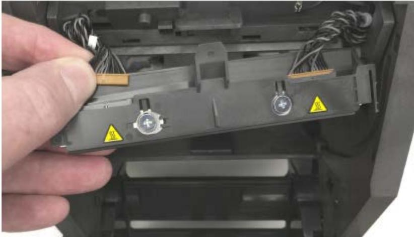
c) Insérez l'attache centrale de la tête d'impression dans le logement central du bras de commande de la tête d'impression.
