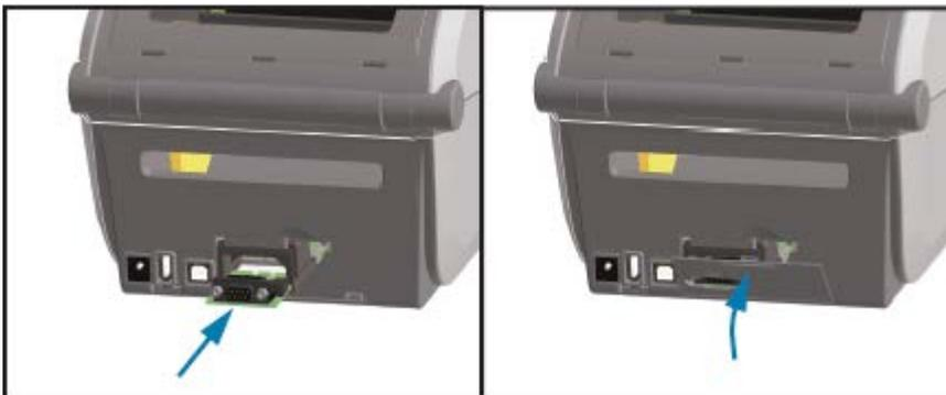
2. Alignez le bas de la porte du port série sur le rebord inférieur de l'ouverture d'accès au module. Faites pivoter la porte vers le haut et fermez le couvercle.
