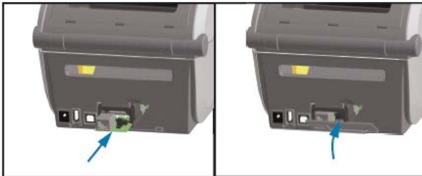
2. Alignez le bas de la porte du port Ethernet sur le rebord inférieur de l'ouverture d'accès au module, puis faites pivoter la porte vers le haut et fermez le couvercle du module.
