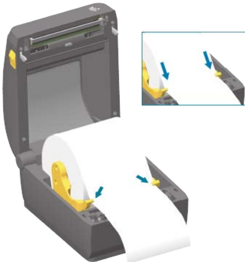
5. Retournez le support et alignez le capteur de support mobile en fonction de votre type de support.
