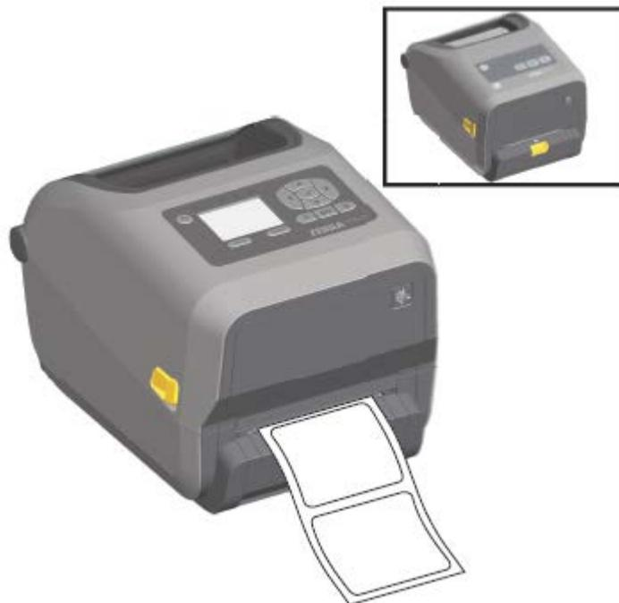
2. Soulevez la doublure au-dessus l'imprimante. Tirez sur le loquet doré situé au centre de la porte du distributeur pour l'éloigner de l'imprimante. La porte s'ouvre.
