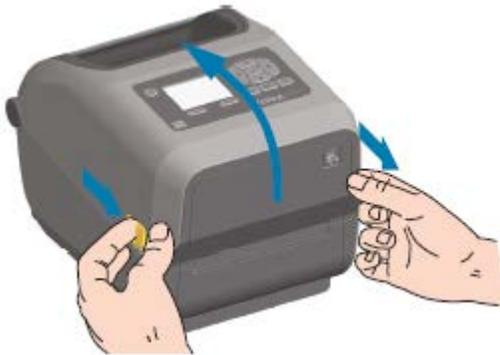
2. Ouvrez les porte-rouleaux de support. Orientez le rouleau de support de manière à ce que sa surface d'impression soit orientée vers le haut lorsqu'il passe sur le contre-rouleau (d'entraînement). Ouvrez les guides de support avec votre main libre et placez le rouleau de support sur les porte-rouleaux, puis
