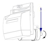
4. 그림 17을 참조하십시오. 예방용 유지 보수 키트(부품 번호 47362)의 면봉을 사용하여 커터, 상부 표면 (1) 및 커터 날 (2)을 닦으십시오. 예방용 유지 보수 키트 대신, 이소프로필 알코올 (최소 90%)과 탈이온 용수 (최대 10%)의 용액에 담근 깨끗한 면봉을 사용해도 됩니다. 솔벤트가 기화되도록 놓아둡니다.
