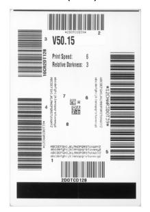
4. 그림 21 및 표 21을 참조하십시오. 테스트 라벨을 확인하여 어떤 것이 응용 프로그램에 가장 적합한 인쇄 품질인지 결정합니다. 바코드 확인 장치가 있는 경우, 이를 사용하여 바/ 공백을 측정하고 인쇄 명암을 계산합니다. 바코드 확인 장치가 없는 경우, 눈으로 확인하거나 시스템 스캐너를 사용하여 자가 테스트에서 인쇄된 라벨을 바탕으로 최적의 농도 설정을 선택합니다.
