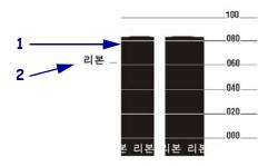
미디어 센서 프로파일 (그림 24)미디어 센서 판독값은 센서 프로파일에 바 형태와 플랫 영역으로 표시됩니다. 바(1)는 라벨(망)사이의 간격을 나타내며 아래쪽 영역(2)은 라벨의 위치를 나타냅니다. 센서 프로파일 출력을 미디어의 공백 길이와 비교했을때 바는 미디어에서의 간격과 동일한 거리만큼 떨어져 있어야 합니다. 떨어져 있는 거리가 동일하지 않은 경우, 프린터가 간격이 어디에 위치해 있는지 인식하지 못하기때문입니다.
