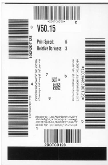
4. 请参见图 21 和表 21。检查测试标签并确定哪张标签具有适合您应用的最佳打印质量。如果您具有一个条形码检验器，可以使用它测量条形 / 空白并计算打印对比度。如果您没有条形码检验器，可以使用目测方法或系统扫描仪根据在本自检中打印的标签选择最佳深度设置。
