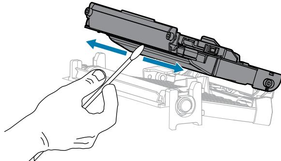
5. Dok ručno okreće valjak za štampanje, očistite ga temeljno štapićem sa vatom. Sačekajte da rastvarač ispari.
