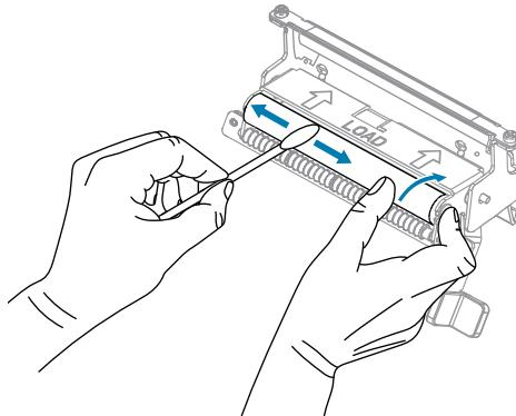
6. Koristite štapić sa vatom da biste uklonili višak lepka sa trake za otcepljivanje/odlepljivanje. Sačekajte da rastvarač ispari.
