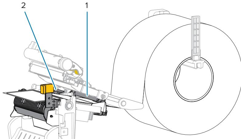
5. Gurnite nadole polugu za otpuštanje mehanizma za odlepljivanje da biste otvorili sklop za odlepljivanje.
