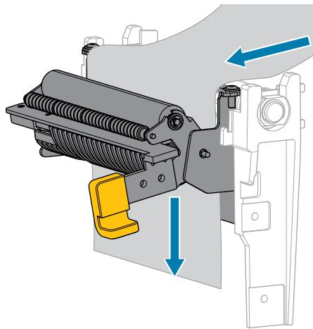
8. Zatvorite sklop za odlepljivanja pomoću poluge za otpuštanje mehanizma za odlepljivanje.
