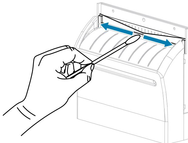
8. Kada rastvarač ispari, namočite čisti štapić sa vatom u silikonsko mazivo višeg viskoziteta ili PTFE uljano mazivo opšte namene.
