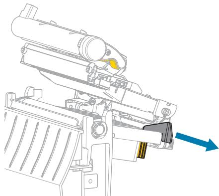
4. Umetnute medije kao što je prikazano. Uverite se da medij prolazi kroz prorez na transmisivnom senzoru medija (1) i ispod unutrašnje vodice za medij (2). Medij treba samo da dodiruje pozadinu proreza transmisivnog senzora medija.
