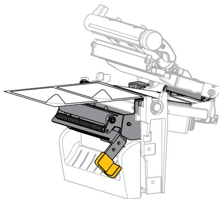
7. Umetnute podlogu iza sklopa za odlepljivanje. Pobrinite se da kraj podloge pada izvan štampača.
