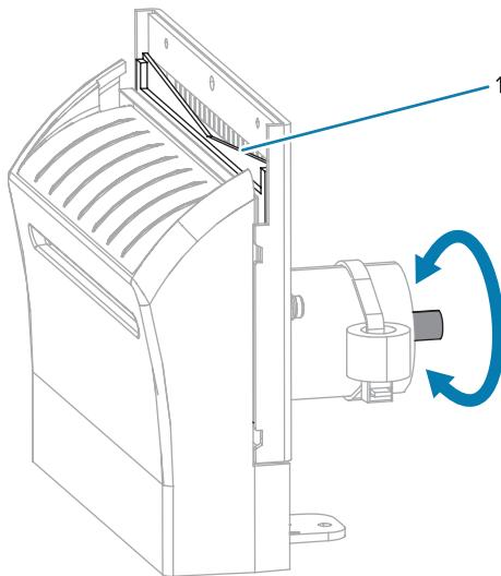
7. Pomoću štapića sa vatom iz kompleta za preventivno održavanje (broj artikla 47362) brišite duž gornje rezne površine i sečivo sekača. Umesto kompleta za preventivno održavanje možete da koristite čisti štapić sa vatom umočen u izopropil-alkohol čistoće 90%. Sačekajte da rastvarač ispari.
