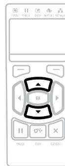
▼ y ▲ indican que se puede cambiar un valor. Cualquier cambio que realice se guardará de inmediato. Presione la **FLECHA HACIA ARRIBA** o la **FLECHA HACIA ABAJO** para desplazarse por los valores aceptados.
