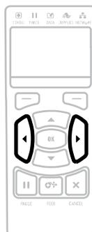
Para desplazarse por los elementos en un menú del usuario, presione la **FLECHA IZQUIERDA** o la **FLECHA DERECHA**.
