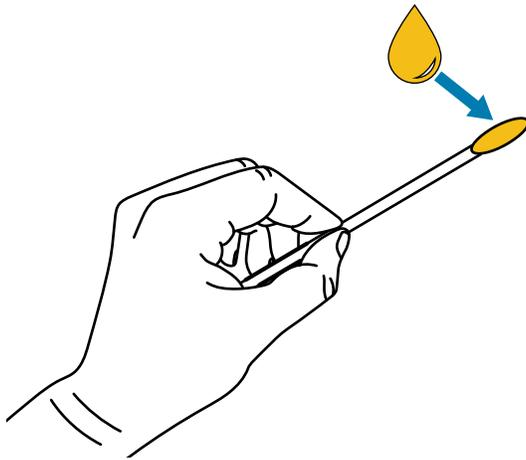
9. Tragen Sie eine gleichmäßige Schicht auf alle frei liegenden Oberflächen beider Schneidmesser auf. Entfernen Sie überschüssiges Öl, damit es nicht mit dem Druckkopf oder der Walzenrolle in Kontakt kommt.
