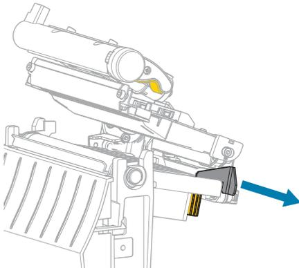
4. Legen Sie das Medium wie gezeigt ein. Stellen Sie sicher, dass das Medium durch den Schlitz im Durchlichtsensor (1) und unter der inneren Medienrandführung (2) durchgeführt ist. Das Medium sollte das hintere Ende des Schlitzes am Durchlichtsensor gerade berühren.
