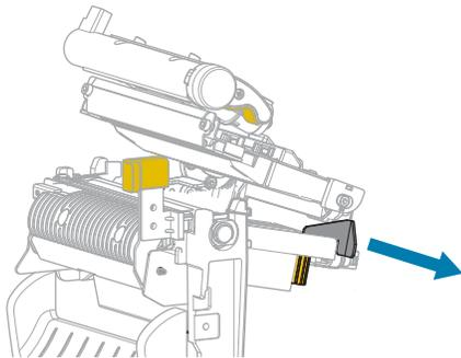
4. Legen Sie das Medium wie gezeigt ein. Stellen Sie sicher, dass das Medium durch den Schlitz im Durchlichtsensor (1) und unter der inneren Medienrandführung (2) durchgeführt ist. Das Medium sollte das hintere Ende des Schlitzes am Durchlichtsensor gerade berühren.
