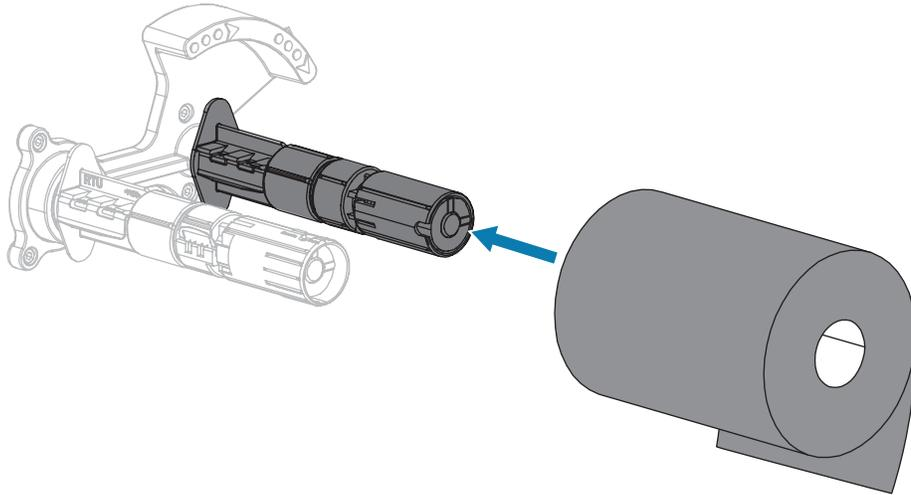
4. Der Drucker wurde mit einem leeren Farbbandkern auf der Farbband-Aufwickelspule geliefert. Wenn dieser Kern nicht mehr vorhanden ist, setzen Sie einen leeren Farbbandkern auf die Farbband-Aufwickelspule. Schieben Sie den Kern so weit wie möglich nach hinten.
