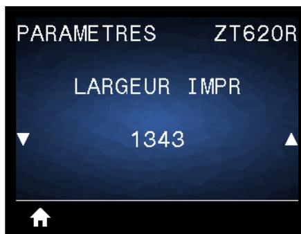
Indiquez la largeur des étiquettes utilisées, en points. La valeur par défaut est la largeur maximale de l'imprimante, basée sur la valeur de points par pouce de la tête d'impression.
