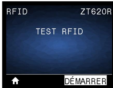
Au cours d'un test RFID, l'imprimante tente d'effectuer une lecture et une écriture sur un transpondeur. Au cours de ce test, aucun mouvement de l'imprimante ne se produit.
