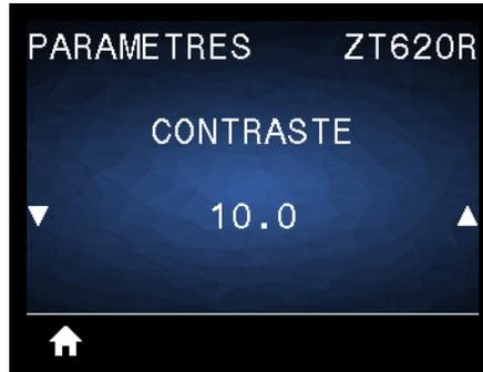
Configurez le contraste d'impression sur la valeur minimale permettant d'obtenir une bonne qualité d'impression. Un réglage à un niveau trop élevé risque de provoquer une impression floue de l'image de l'étiquette, une numérisation incorrecte des codes à barres, le passage de l'encre à travers le ruban ou l'usure prématurée de la tête d'impression.
