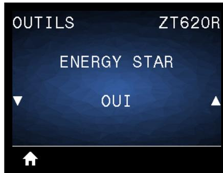
Lorsque le mode Energy Star est activé, l'imprimante passe en mode « veille » après un délai d'attente, réduisant ainsi la consommation électrique. Appuyez sur un bouton du panneau de commande pour que l'imprimante soit de nouveau active.
