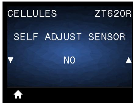
Activez ce paramètre pour que l'imprimante tente de détecter les paramètres du papier automatiquement. Il sera peut-être nécessaire de calibrer manuellement l'imprimante si ce paramètre ne détecte pas votre papier correctement.
