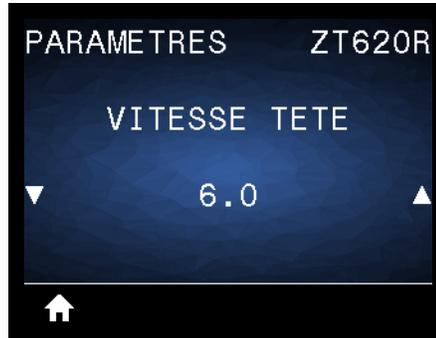
Sélectionnez la vitesse d'impression d'une étiquette en pouces par seconde (pps). Généralement, plus la vitesse est faible, meilleure est la qualité d'impression.
