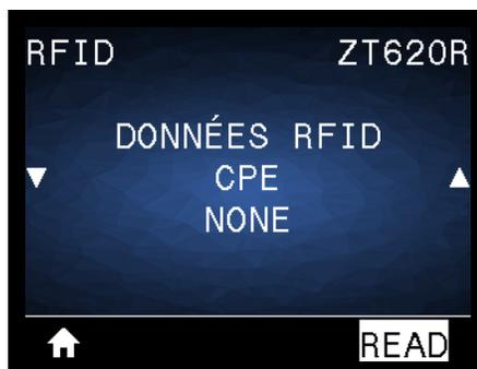
Lisez les données d'étiquettes indiquées et renvoyez-les dans l'étiquette RFID située au-dessus de l'antenne RFID. Aucun mouvement de l'imprimante ne se produit pendant la lecture des données de l'étiquette. La tête d'impression peut être ouverte ou fermée.
