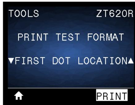
L'imprimante imprime une image pour vous aider à régler la position de l'image sur vos étiquettes, si nécessaire. Les lignes sur l'image sont imprimées à partir du haut et du côté gauche de l'étiquette pour vous permettre d'identifier ce qui doit apparaître dans le coin supérieur gauche de l'étiquette.
