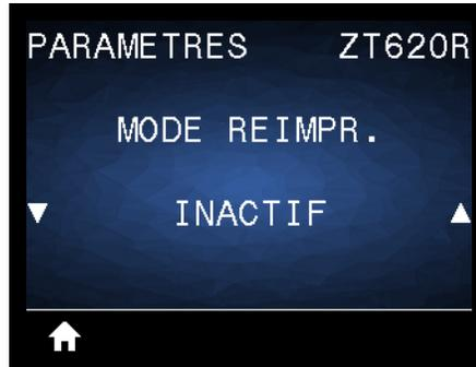
Lorsque le mode de réimpression est activé, vous pouvez réimprimer la dernière étiquette imprimée en appuyant sur la FLÈCHE VERS LE BAS lorsque l'affichage de l'imprimante est inactif (en veille).
