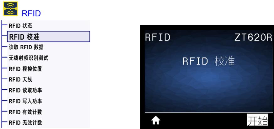
为 RFID 介质启动标签校准。(与介质和色带校准有所不同。)在此过程中，打印机移动介质，校准 RFID 标签位置，然后为正在使用的 RFID 介质确定最佳设置。这些设置包含编程位置、要使用的天线元件和要使用的读取 / 写入功率级别。请参阅 *RFID Programming Guide 3* (《RFID 编程指南 3》)，了解更多详细信息。
