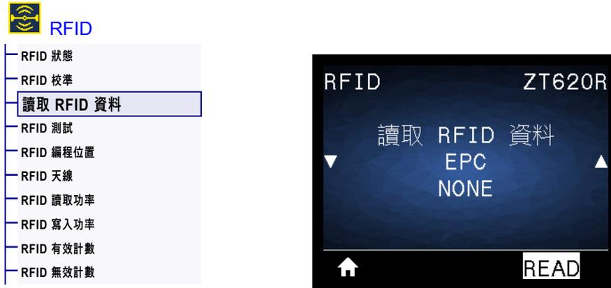
從位於 RFID 天線上的 RFID 標籤讀取並傳回指定標籤資料。讀取標籤資料時印表機不會進行任何動作。印字頭可開啟或關閉。
