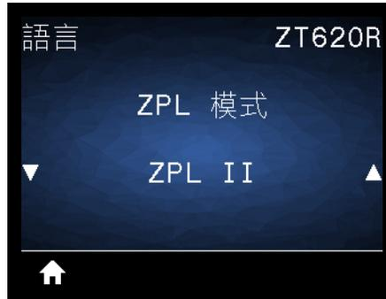
選取符合標籤格式所使用的模式。印表機會接受以 ZPL 或 ZPL II 寫入的標籤格式，並避免重新寫入任何現有的 ZPL 格式之需求。印表機維持在已選取的模式，直到使用其中一種此處所列的方法變更模式為止。
