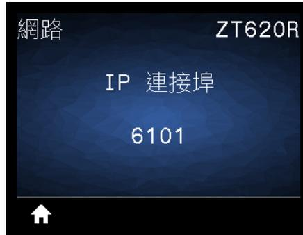
此印表機設定係指 TCP 列印服務接聽的內部有線列印伺服器連接埠號碼。主機的正常 TCP 通訊應直接傳送到此連接埠。
