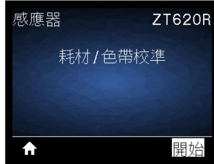
校準印表機以調整耗材和色帶感應器的敏感度。
