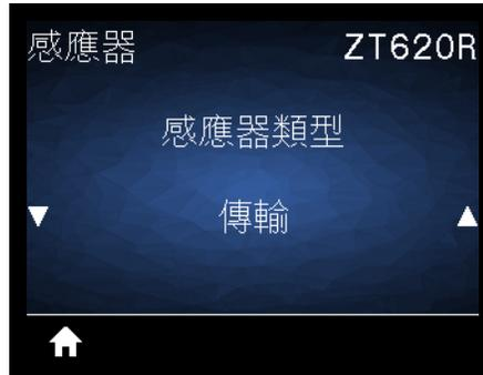
選取適合您正在使用之耗材的耗材感應器。反射感應器通常僅用在黑色標記耗材上。傳輸感應器通常用於其他耗材。
