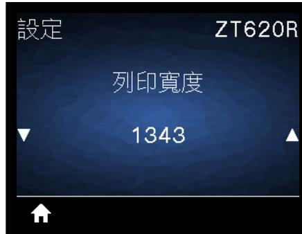
以點數指定使用中標籤的寬度。根據印字頭的 DPI 值，預設值是印表機的最大寬度。
