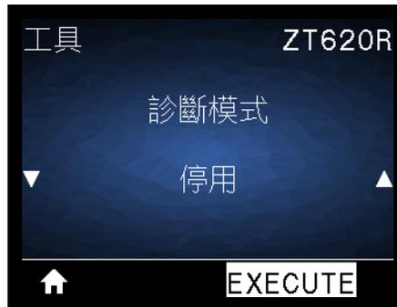
使用此診斷工具，可讓印表機以十六進位值輸出所接受的全部資料。如需詳細資訊，請參閱 [通訊診斷測試](#) 於第 225 頁。
