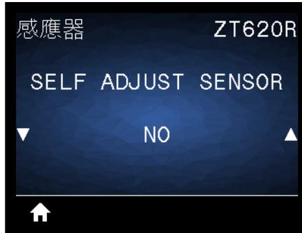
啟用此設定可讓印表機嘗試自動偵測耗材設定。如果此設定無法正確偵測耗材，您仍可能需要手動校準印表機。
