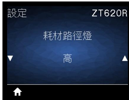
設定耗材用盡時照亮耗材路徑的指示燈亮度。
