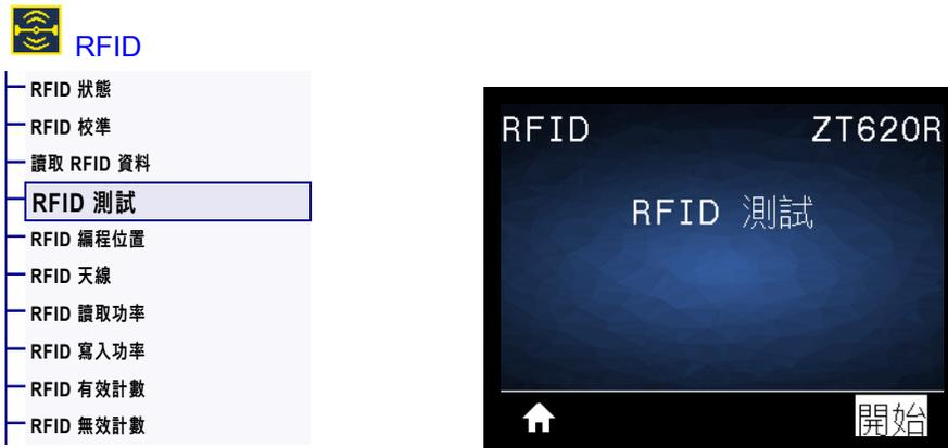
在 RFID 測試期間，印表機會嘗試讀取和寫入詢答機。執行此測試時印表機不會進行任何動作。
