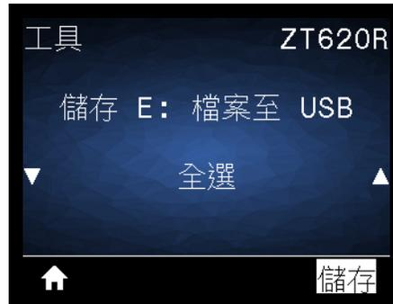
「全選」選項可用於將印表機上所有可用的檔案儲存到 USB 快閃磁碟機上。將對所複製的任何 .ZPL 檔案進行後處理，讓檔案內容適合傳送到印表機以便正常執行。
