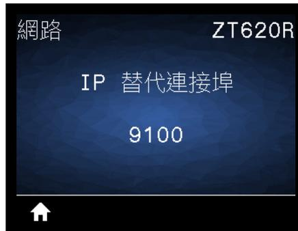
此指令可設定替代 TCP 連接埠的連接埠號碼。
