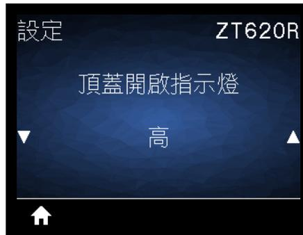
設定耗材擋門開啟時亮起的指示燈亮度。
