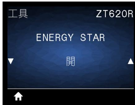
啟用能源之星模式時，印表機會在逾時期間後進入「睡眠」模式，從而降低耗電量。按下控制面板上的任何按鈕，可讓印表機回到作用中狀態。
