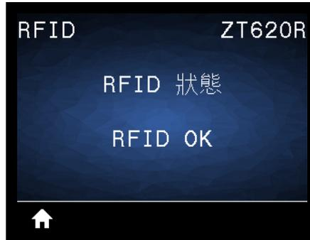
顯示印表機的 RFID 子系統狀態。
