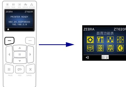
在閒置顯示 (圖 12 於第 91 頁) 中，按下左側選取以移至印表機的主功能表 (圖 13 於第 91 頁)。
