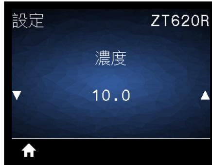
將列印濃度設定為足以提供良好列印品質的最低設定值。如果將明暗度設得太高，標籤影像可能無法清楚列印、條碼可能無法正確掃描、色帶可能腐蝕且印字頭可能提早磨損。
