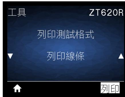
印表機會初始化測試順序，以各種速度多次列印墨水 / 印字頭的測試影像。在調整印表機的機械組合或判定是否有任何無法運作的印字頭零件時，您可以使用這些測試標籤。
