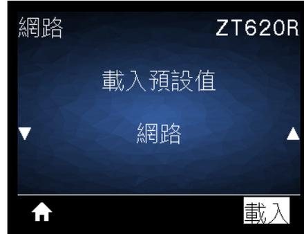
將特定印表機、列印伺服器及網路設定回復為原廠預設值。載入預設值時請小心謹慎，因為您需要重新載入以手動方式變更的所有設定。您可透過兩個使用者功能表使用此功能表項目，每個功能表都具有不同的預設值。
