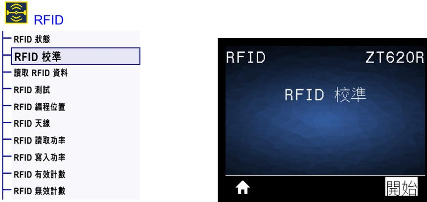
針對 RFID 耗材初始化標籤校準。(與耗材和色帶校準不同。) 程序期間，印表機會移動耗材、校準 RFID 標籤位置，並決定所用 RFID 耗材的最佳設定。這些設定包括程式位置、要使用的天線元件和要使用的讀取 / 寫入功率等級。如需詳細資訊，請參閱《RFID Programming Guide 3 (RFID 程式指南 3)》。
