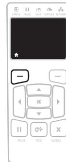
按下左側選取以離開首頁功能表，並回到閒置顯示。若在主功能表非使用狀態達 15 秒，此印表機將自動回到顯示閒置。
