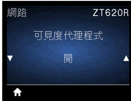
將印表機連線至有線或無線網路時，其將使用加密且經認證驗證的網路通訊端連線，透過雲端式 Zebra Printer Connector 嘗試連線至 Zebra Asset Visibility Service。印表機會傳送搜尋資料和設定及警告資料。「不」會傳輸透過任何標籤格式列印的資料。
