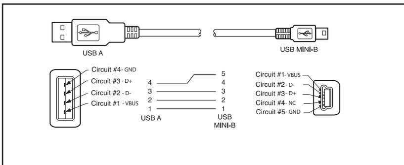
Codice P1031365-055; da Mini USB a 4 posizioni a USB a 4 pin (con pressacavo)
