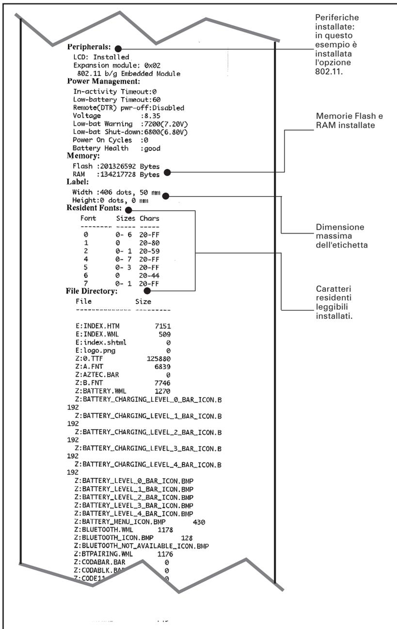
Figura 27c: Esempio di etichetta di configurazione (continuo)
