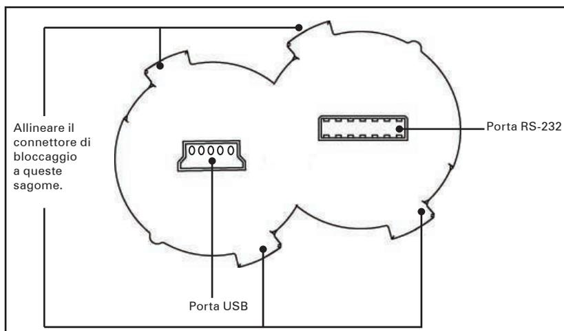
**Figura 20: Pressacavo della porta di comunicazione**
