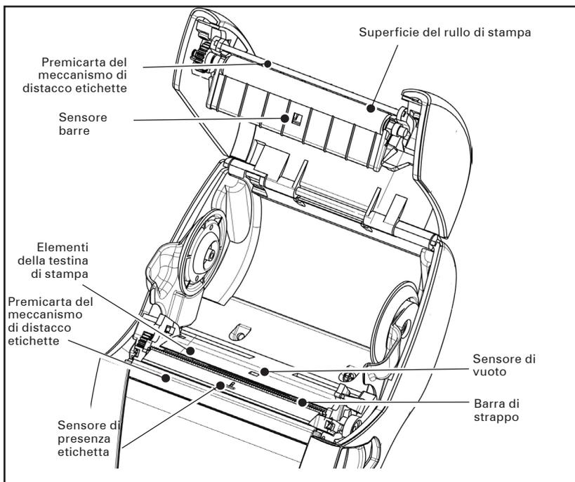
**Figura 25: Pulizia delle stampanti serie QLn Linerless**
