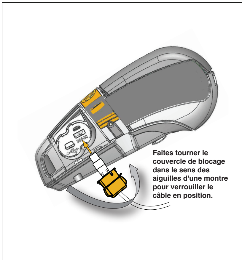
Figure 23 : diminution de la tension du port de communication (modèle QLn420)
