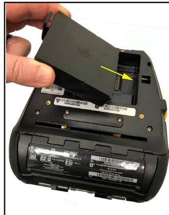
4. Mueva la batería en el compartimiento, como se muestra, hasta que quede fija en posición.
