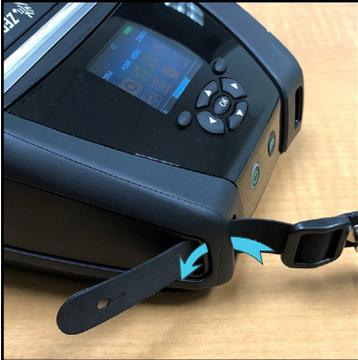
1. Inserte el extremo de la correa para el hombro detrás del montante en la parte frontal de la impresora y dele una vuelta al montante.
