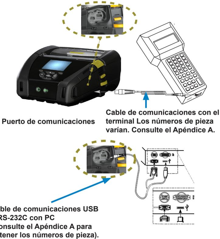
El otro extremo del cable debe conectarse al terminal host tal y como se muestra en la Figura 18, o a un puerto serie o USB en una computadora. La impresora ZQ630 está configurada con el controlador de la interfaz HCI abierta para USB que le permite comunicarse con dispositivos basados en Windows®.
