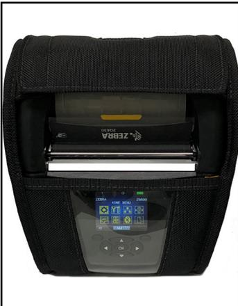
2. Deslice la impresora en el estuche, de forma que la pantalla LCD se pueda visualizar desde la ventana de plástico.
