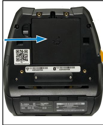
2. Gire el sujetador de cinturón (si existiera) para tener acceso al compartimiento de la batería o extráigalo completamente.
