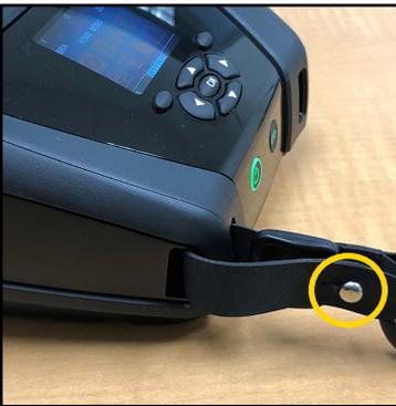
2. Inserte el orificio en el extremo de la correa sobre el montante metálico (marcado con un círculo) para asegurarlo.
