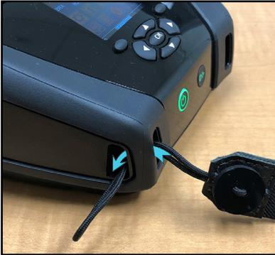
1. Introduzca el lazo en el extremo de la correa a través de la ranura ubicada en la parte delantera de la impresora como se muestra a continuación.
