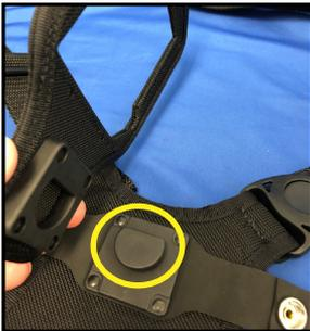
3. Alinee los orificios del panel de montaje con los orificios de montaje de la parte inferior de la impresora (marcados con un círculo). Use un destornillador hexagonal de 4 mm, dos tornillos n.º 6-32 de 0,375 pulg. (marcados con un círculo verde) y dos arandelas n.º 6 para fijar el panel de montaje a la parte superior de la impresora. Fije los dos (2) tornillos n.º 6-32 de 0,625 pulg. (marcados con un círculo rojo) y las arandelas en la parte inferior del panel de montaje.
