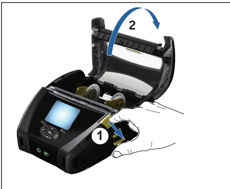
2. Separe los soportes del papel. Inserte el rollo de papel (con la orientación que se muestra) entre los soportes y permita que los soportes aseguren el papel en posición. Los soportes se ajustarán solos según el ancho del papel, y el rollo de papel debe poder girar libremente en los soportes.
