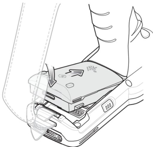
4. Gire la parte inferior de la batería hacia el compartimento de la batería.
