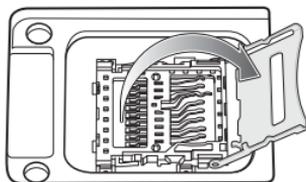
4. Coloque la tarjeta microSD en el área de contacto con los contactos hacia abajo.
