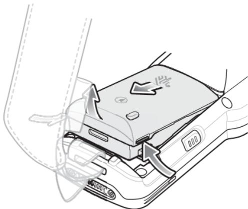
3. Alinee la nueva batería con el compartimento de la batería.
