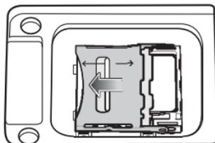
6. Vuelva a colocar la cubierta de la tarjeta microSD y asegúrese de que esté colocada correctamente.
