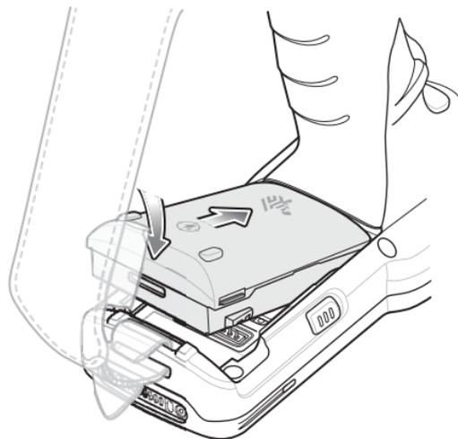
2. Gire la parte inferior de la batería hacia el compartimento de la batería.
