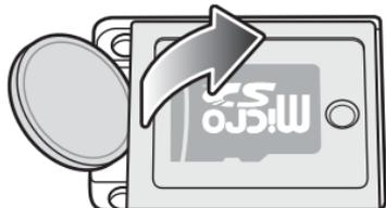
2. Deslice el soporte para tarjeta microSD a la posición abierta.
