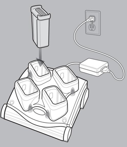
Chargeur de batterie à quatre logements
