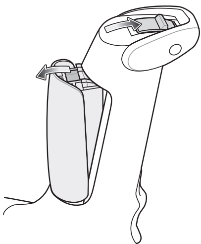
図 1-4 RFID スレッドのバッテリーの取り外し
