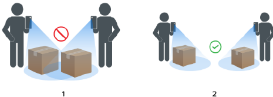
Abbildung 9 Abmessung mit mehreren Geräten
