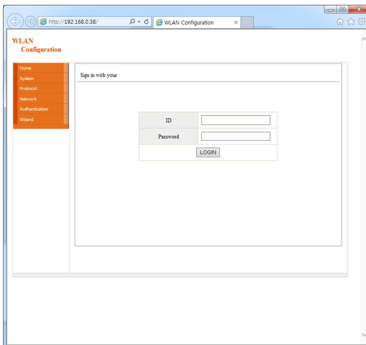
Nachdem Sie auf **LOGIN** (Anmelden) geklickt haben, werden die Druckerinformationen in einem Browserfenster angezeigt. Die WLAN-Konfigurationseinstellungen können auf diesem Bildschirm oder mithilfe des Assistenten („Wizard“) geändert werden.
