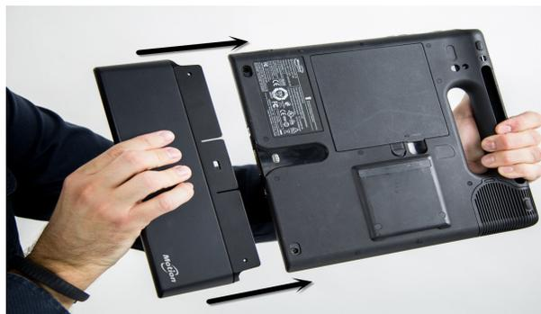
4. Zum Entfernen des RFID-Weitbereichslesers stecken Sie den Finger in die Aussparung oben am Lesegerät, ziehen Sie die Lasche zurück, und ziehen Sie das Lesegerät vom Tablet PC ab.
