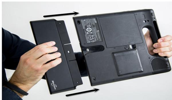
4. Para remover o Leitor de longo alcance RFID, insira seu dedo no slot na parte superior do leitor, puxe para trás a guia e deslize o leitor do Computador Tablet.
