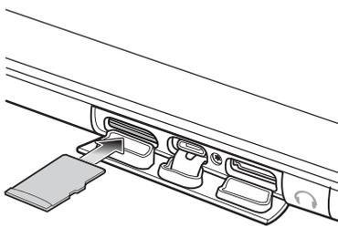
2. Inserte la tarjeta microSD en la ranura con los contactos orientados hacia abajo.
