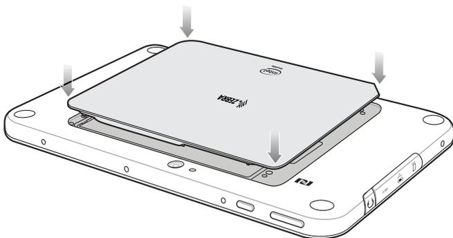
9. Presione con cuidado hacia abajo alrededor del borde de la cubierta. Asegúrese de que la cubierta está colocada correctamente.
