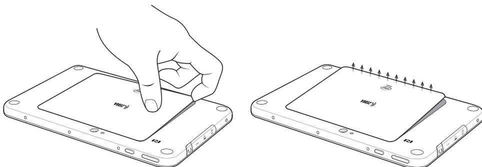
3. Levante con cuidado la cubierta de la batería de la ET55.
