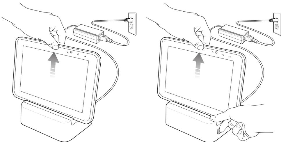
Para extraer la ET5X de la base de comunicación, pulse el botón de liberación situado en el lado derecho de la base y levante la ET5X. Sujete la base ayudándose del pulgar.
