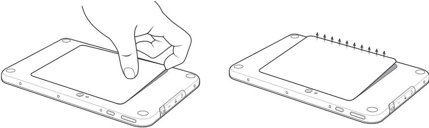
2. Levante con cuidado la cubierta de la batería de la ET5X.
