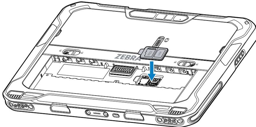
10. Insérez d'abord le bas de la batterie dans le compartiment prévu à cet effet au dos du terminal.
