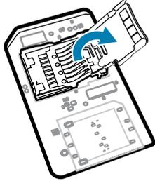
6. Insérez la carte microSD dans la trappe du support en veillant à ce qu'elle s'insère parfaitement dans les crans de retenue situés de part et d'autre du support.
