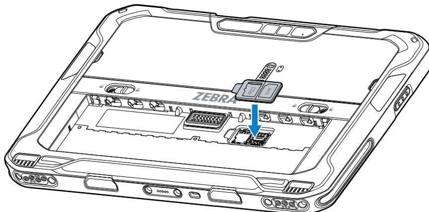
9. Insérez d'abord le bas de la batterie dans le compartiment prévu à cet effet au dos du terminal.
