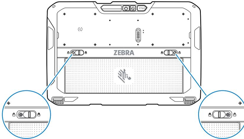
2. À l'aide d'un tournevis cruciforme, fixez les vis aux loquets.
