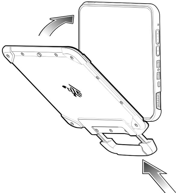
2. Insérez le bas de la tablette dans la partie inférieure de la station d'accueil (1), en alignant les contacts de charge de la tablette avec les broches de connexion de la station d'accueil.
