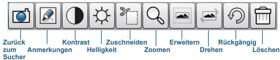
Motion QuickNav-Symbolleiste für die Bearbeitung
