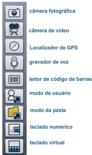
Barra de ferramentas do Motion QuickNav
