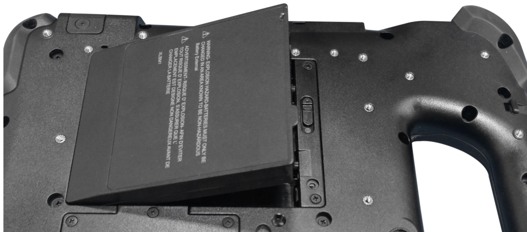
Figura 4 Installazione della batteria
