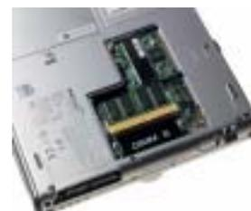
4. Schieben Sie das Ersatzmodul in einem Winkel von 25° in den Steckplatz ein, so dass es fest eingesetzt ist. Drücken Sie es leicht an, bis es einrastet.
