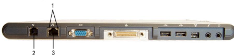
**Connecteurs pour modem COM et LAN** : (1) DEL RJ-45 ; (2) Modem RJ-11 ; (3) LAN RJ-45
