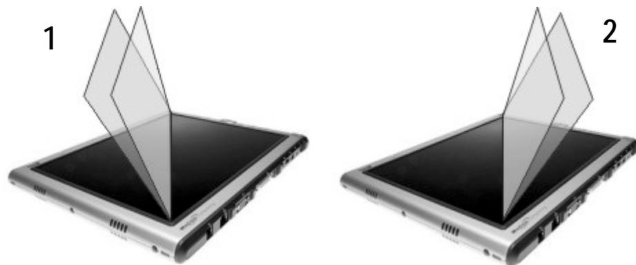
1 Angle dévié gauche avec angle étroit de capture ; 2 Angle dévié droit avec angle étroit de capture
