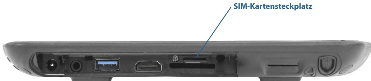
3. Schieben Sie die SIM-Karte mit der abgeschrägten Ecke zum Tablet und mit den Kontakten nach unten in den Steckplatz, bis sie hörbar einrastet
