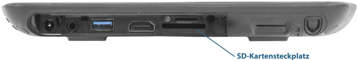
3. Schieben Sie die SD-Karte mit den Kontakten nach unten in den Steckplatz, bis sie hörbar einrastet
