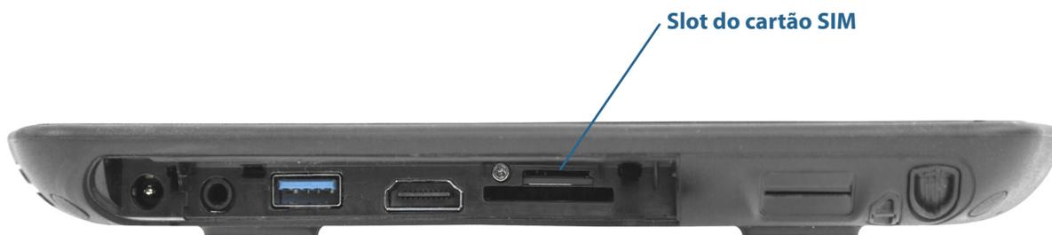
3. Empurre o cartão SIM com o lado chanfrado voltado para o tablet e os contatos voltados para baixo no slot até que ele se encaixe no lugar.
