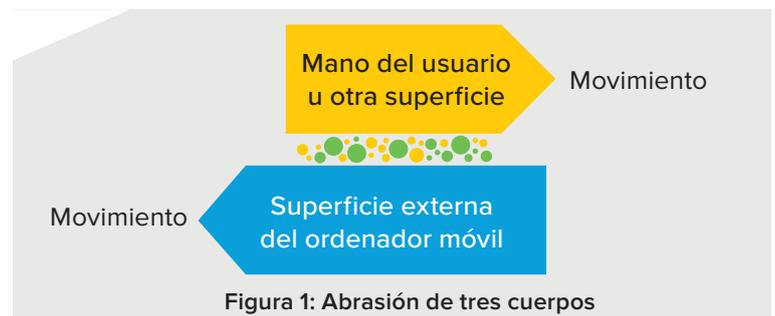
El movimiento relativo entre las superficies de contacto provoca que los contaminantes se lleven consigo parte del exterior del ordenador móvil y que, en última instancia, originen microabrasiones. Si los contaminantes no se retiran rápidamente, las microabrasiones resultarán más visibles y provocarán un tacto rugoso.
