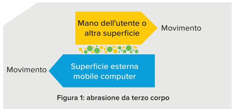
Il moto relativo tra le superfici di contatto fa sì che i contaminanti scalfiscano l'esterno del mobile computer, fino a creare delle microabrasioni. Se non si provvede a eliminare prontamente i contaminanti, le microabrasioni si ingrandiscono e rendono ruvido il rivestimento esterno del terminale.
