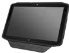
SlateMate Data Acquisition Mobile (lector de códigos de barras y RFID de alta frecuencia)
