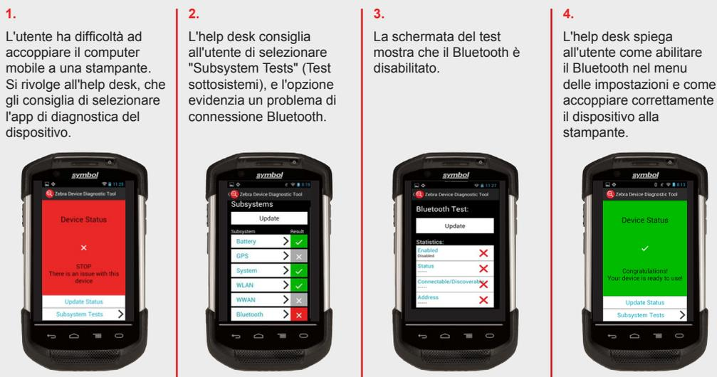
FIG. 3: ESEMPIO DI FLUSSO DI LAVORO PER IL TRIAGE E LA RISOLUZIONE DEI PROBLEMI CON IL SERVIZIO DI DIAGNOSTICA DISPOSITIVO
